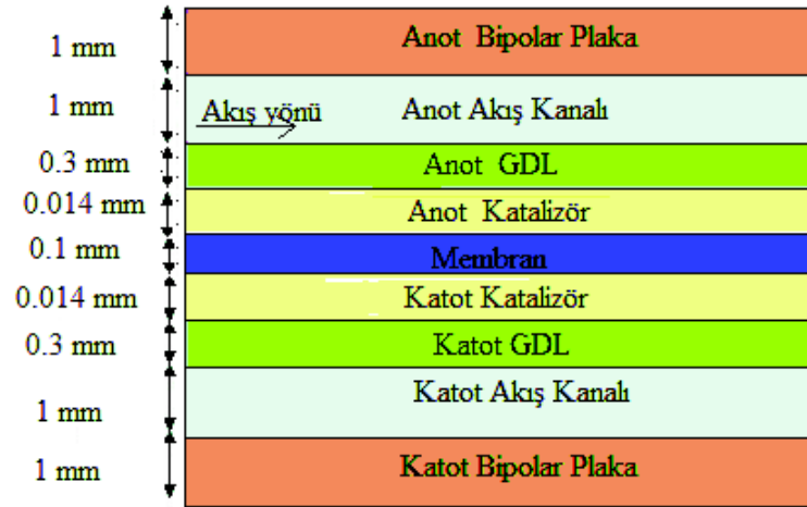
Şekil 1.10. Yakıt pilinin iki boyutlu şematik sunumu.
