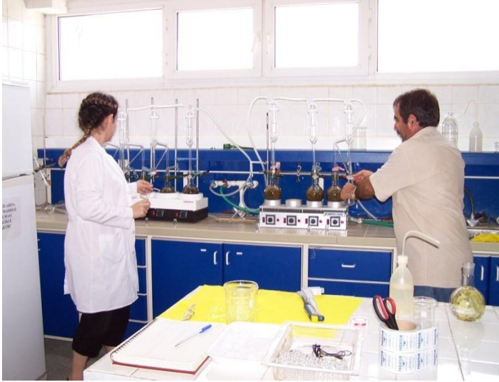
Şekil 3.8. Neo-clevenger ile uçucu yağ eldesi.
