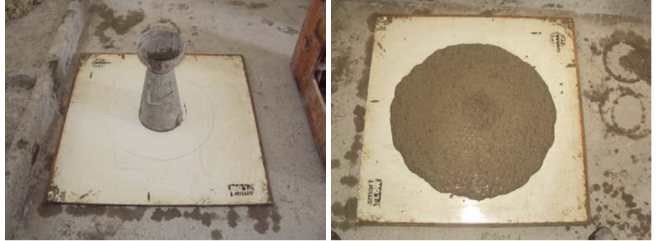
Şekil 5.2 Yayılma çapı deneyinde kullanılan aparatlar
