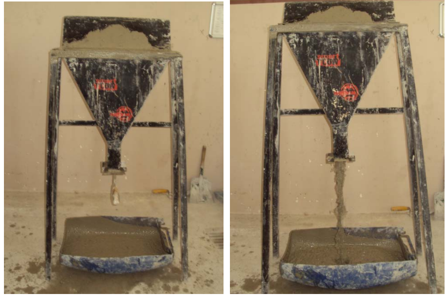
Şekil 5.6 V-hunisi deneyinin yapılışı
