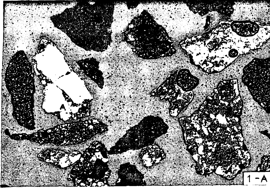
1-A- Areban Formasyonu: Yeşilimsi-gri, çok şeyilli, kötü yuvarlanmış, kötüden çok iyiye boylanmış, kuvars-feldspar kumtaşı (A işaretli), üstteki karbonat formasyonlarından gelmiş parçalarda gözlenmektedir. Görünür porozite yoktur.
