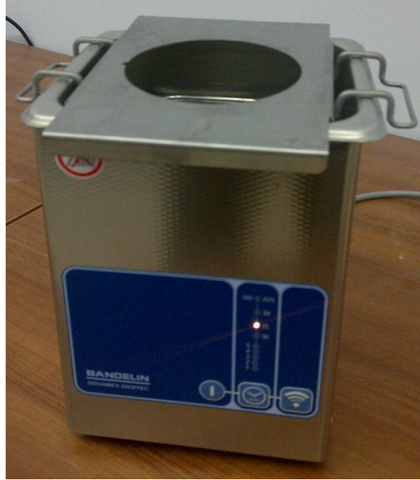
Şekil 3.3. Yüzey temizleme işleminde kullanılan ultrasonik temizleme cihazı.
