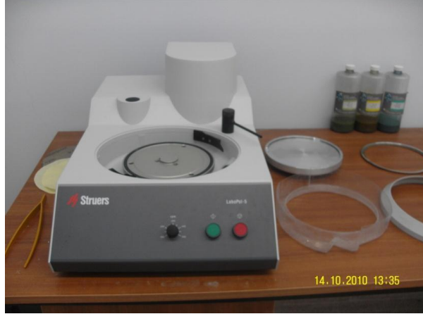
Şekil 3.2. Devir ayarlı, sürekli su akışlı parlatma cihazı.
