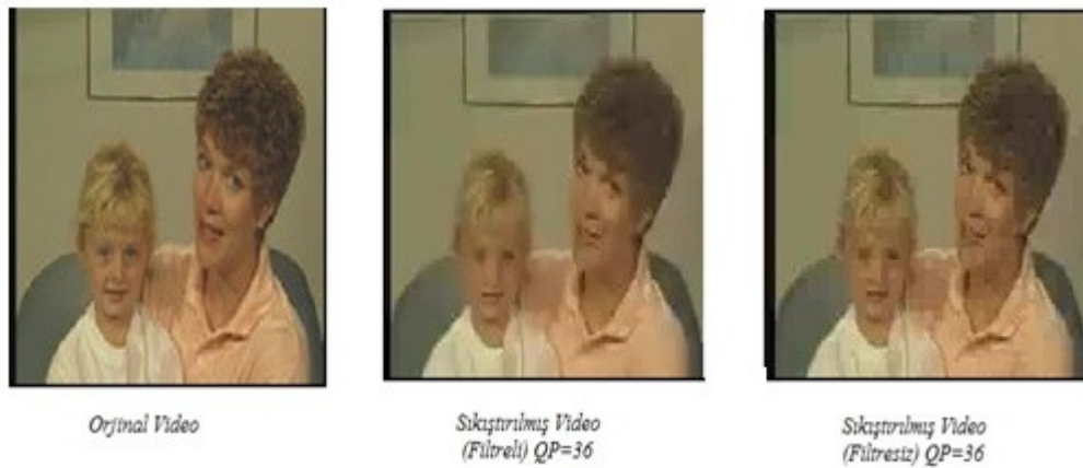
Şekil 2.27 : Filtreleme işleminin video kalitesine etkisi [12].
