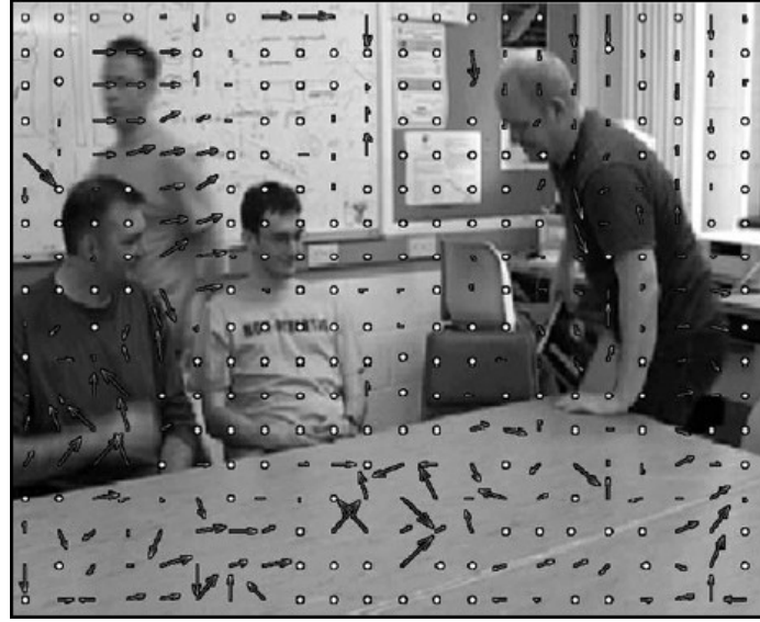
Şekil 2.10 : MPEG-2 hareket kestirimi örneği [6].
