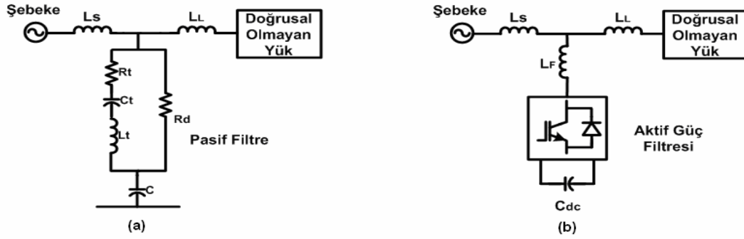
Şekil 3.2 : (a) Şönt pasif filtre (b) Aktif filtre.
