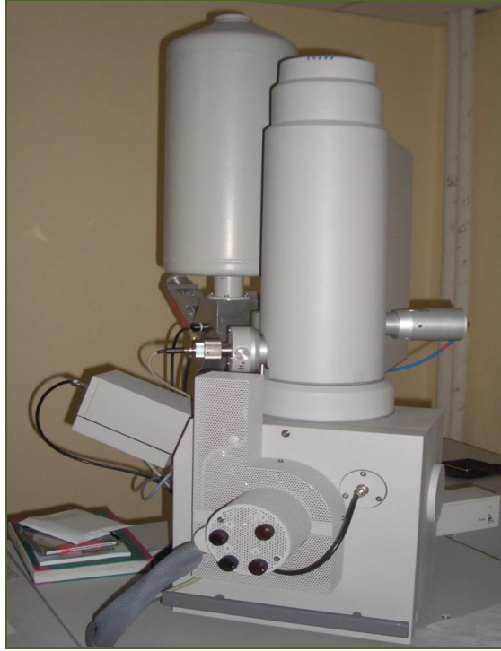
Resim 7. Element analizlerinde kullanılan EDX (Energy Dispersive X-Ray Spectrophotometer) cihazı
