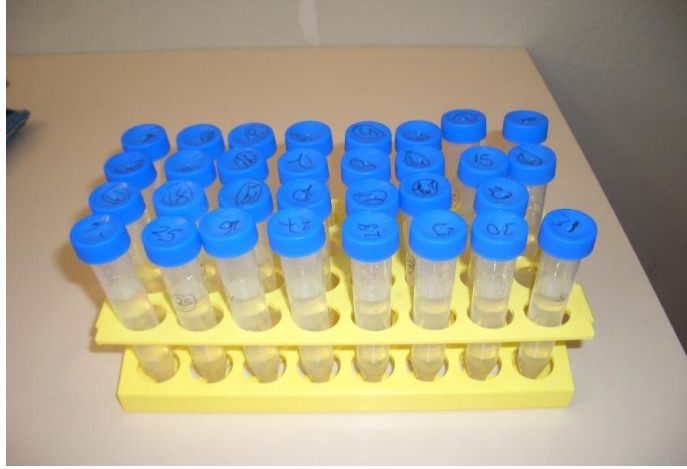
Resim 9. Yaşlandırma işlemi sonrasında ICP-MS cihazında analizleri yapılacak olan solüsyon örnekleri
