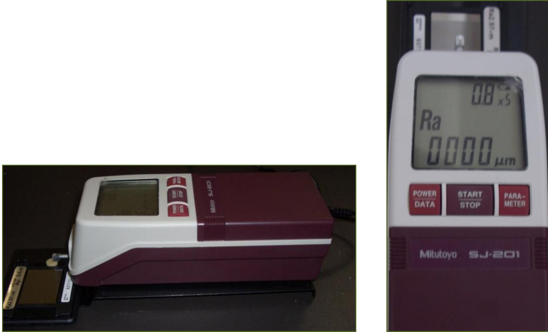
Resim 6. Test örneklerinin yüzey pürüzlülük ölçümlerinde kullanılan profilometre cihazı (SJ 201, Mitutoyo Corp, Kawasaki, Japonya)
