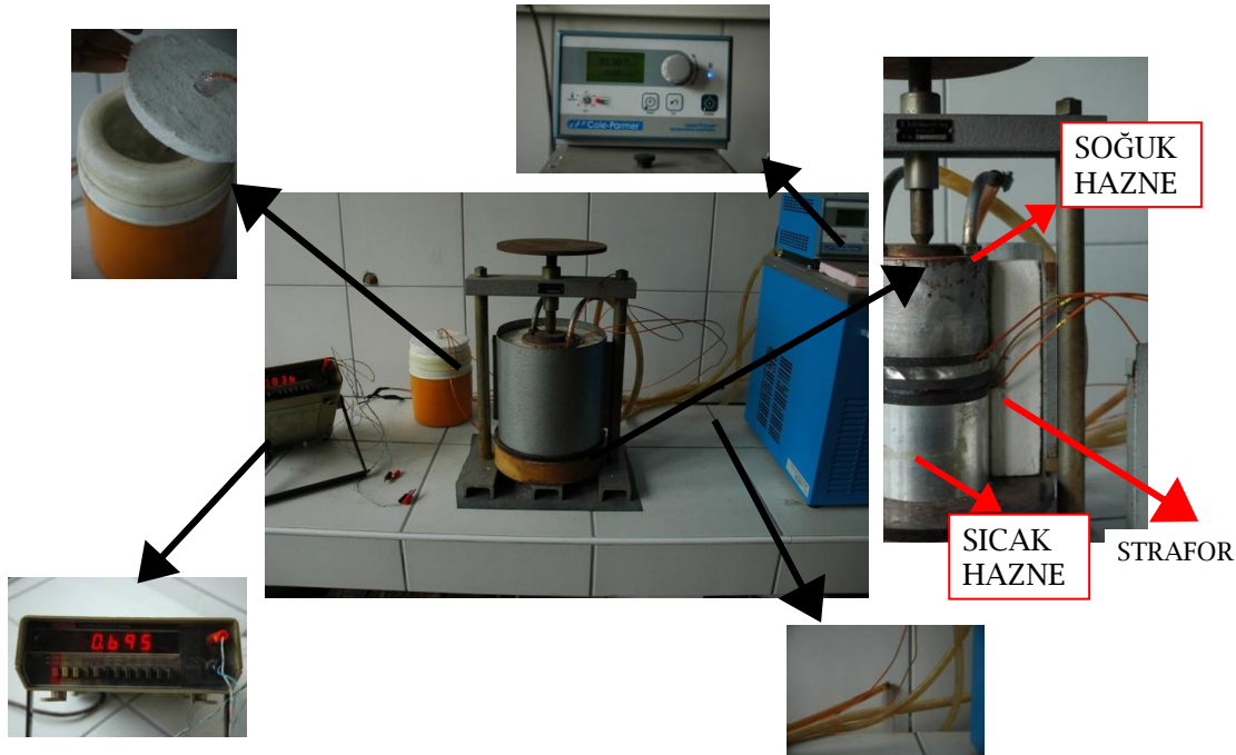
Şekil 7.9 : Isı iletim katsayısı ölçüm düzeneği ve elemanları.
