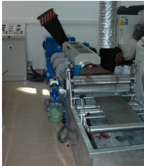
Şekil 6.4 : Çalışmada kullanılan özel tasarım ekstruder
