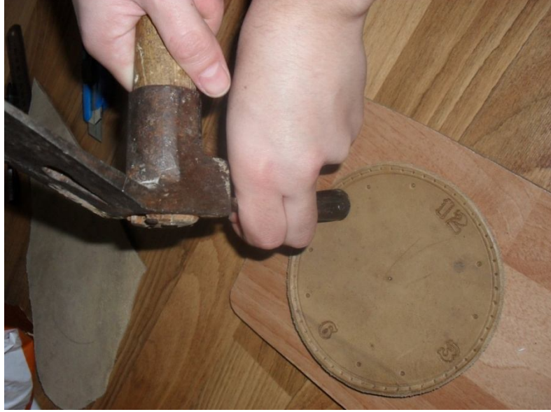
Şekil 43: Yerleri Belirlenen Numaraların Zimba ile Deri Üzerine Geçirilmesi
