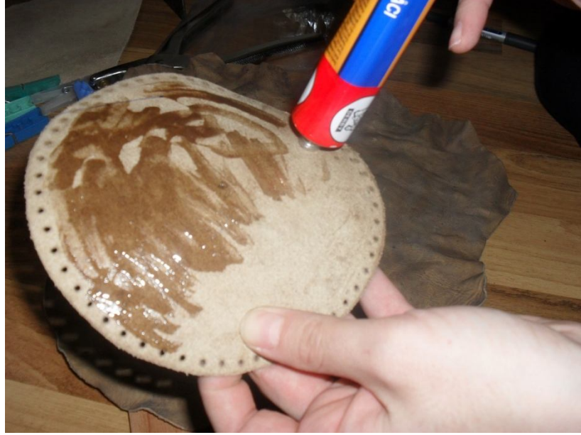
Şekil 45: Yüzeye Yapıştırıcı Sürülmesi
