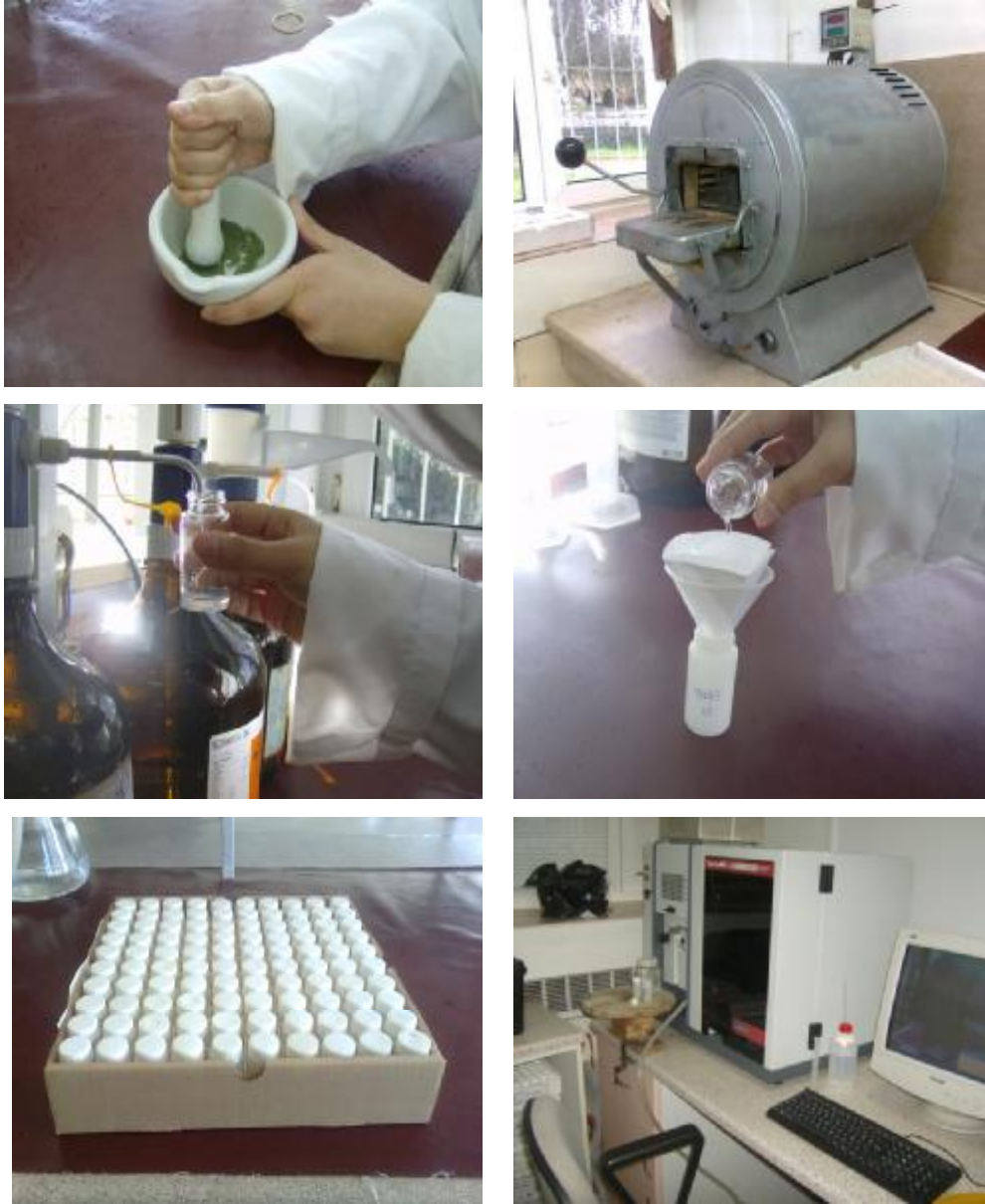
Şekil 3.18. Azot dışında diğer mineral element analizleri için kuru yakma yapılması ve Atomik absorpsiyon spektrofotometrede okunması için süzük işlemlerinin yapılması
