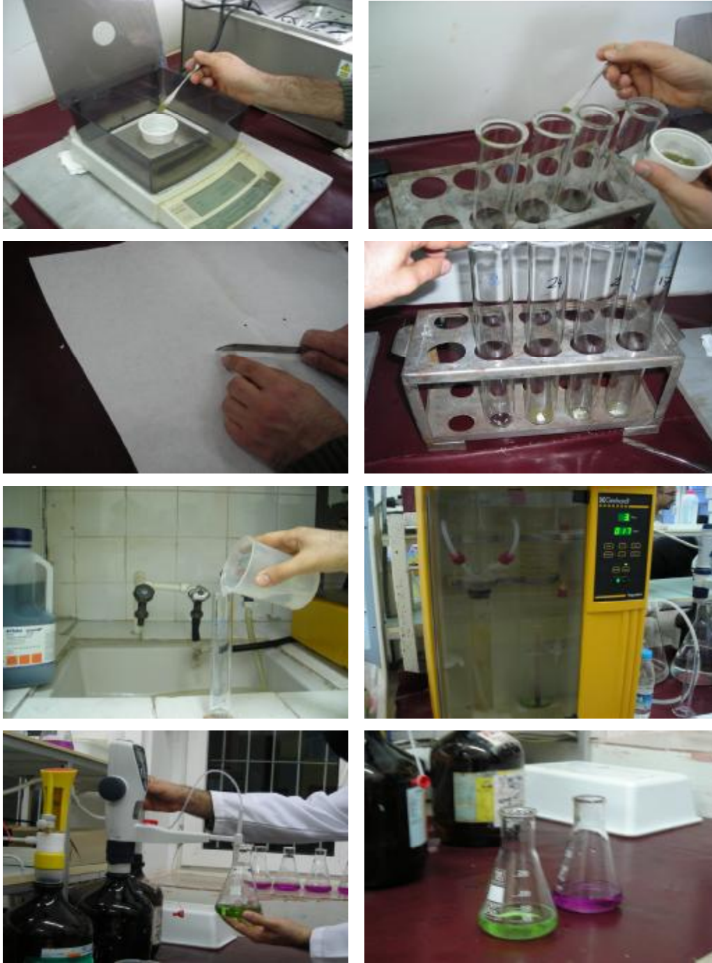
Şekil 3.17. Azot analizinin yaş yakma, destilasyon ve titrasyon aşaması
