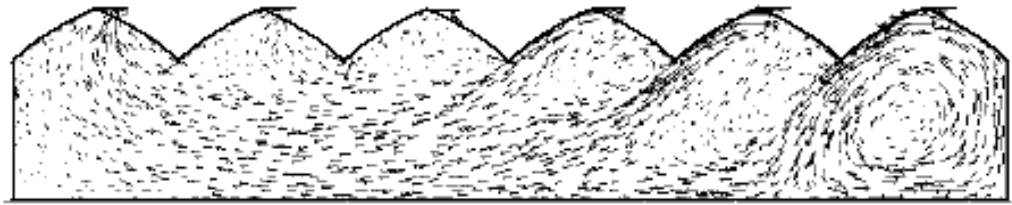
Şekil 2.1. Altı bölmeli yay çatılı serada 3.5 m/s harici hava hızında sera çatı havalandırmasının sera içi hava akış paternine olan etkisi (Kaçıra ve ark., 2004a)
