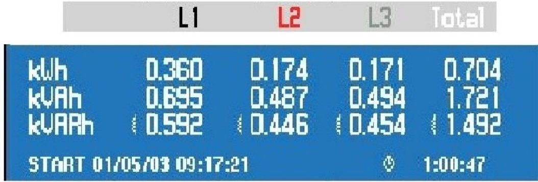
Şekil 7.13. Hava üflemeli soğutma sisteminde 5 °C sıcaklık ve 4 m/s hava hızı için için her bir faz için ve toplam güç tüketim değişimi
