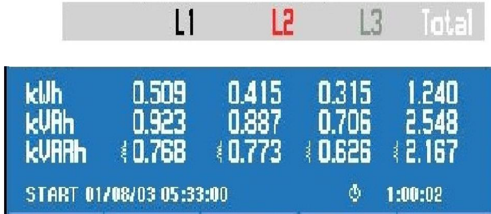
Şekil 7.25. Hava üfleli soğutma sisteminde -20 °C sıcaklık ve 4 m/s hava hızı için için her bir faz için ve toplam güç tüketim değişimi
