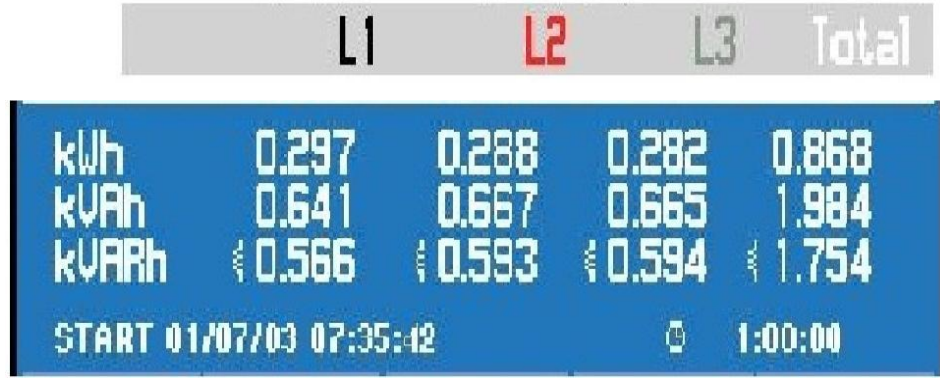
Şekil 7.15. Hava üflemeli soğutma sisteminde -16 °C sıcaklık ve 1 m/s hava hızı için için her bir faz için ve toplam güç tüketim değişimi
