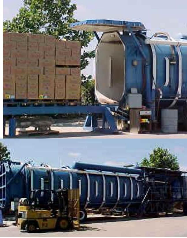
Şekil 2.12. Vakum soğutma sistemi (SVC, 2004)
