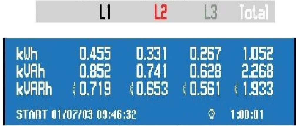
Şekil 7.19. Hava üflemeli soğutma sisteminde -16 °C sıcaklık ve 4 m/s hava hızı için için her bir faz için ve toplam güç tüketim değişimi
