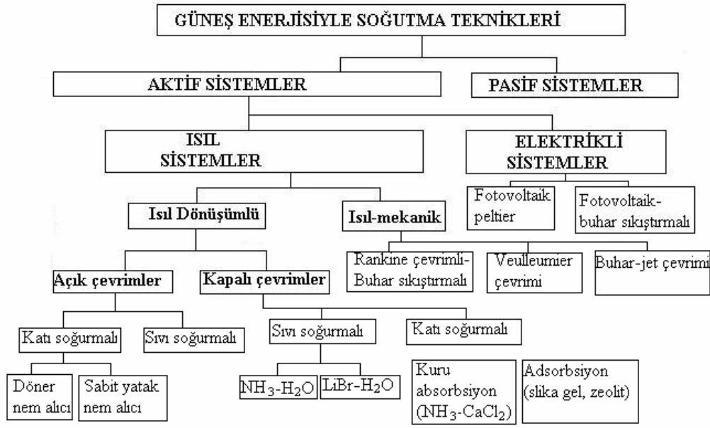
Şekil 2.17. Güneş Enerjisiyle Soğutma Tekniklerinin Sınıflandırması (Büyükalaca ve Yılmaz, 2003).
