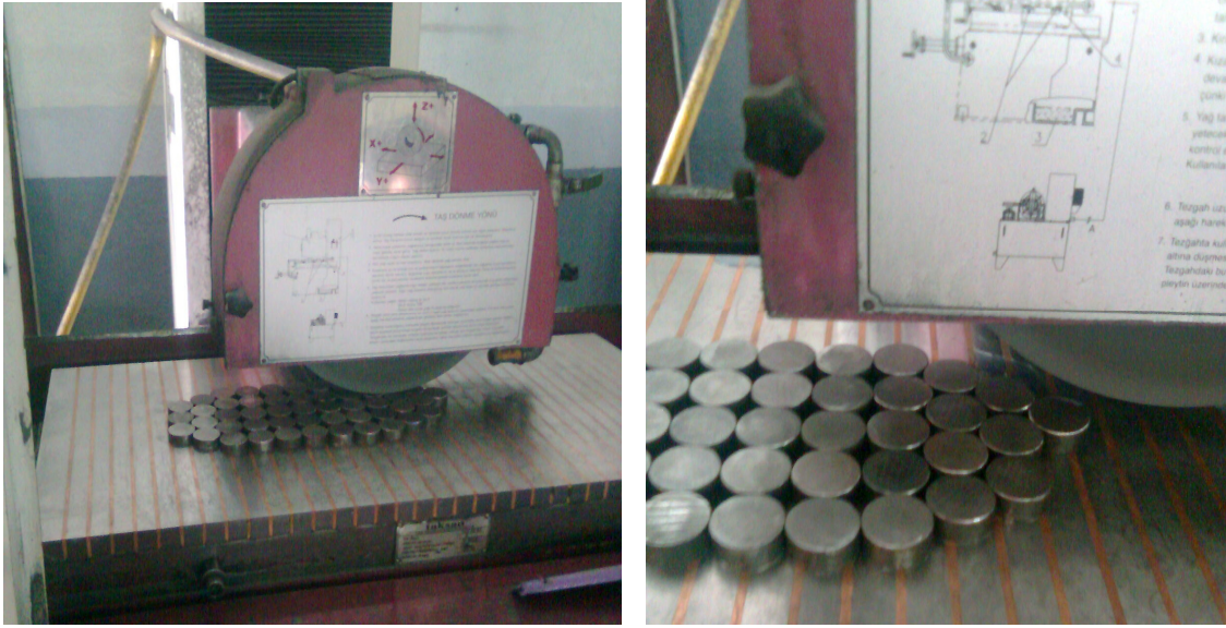
Şekil 5.2 Numunelerin taşlama işlemi.
