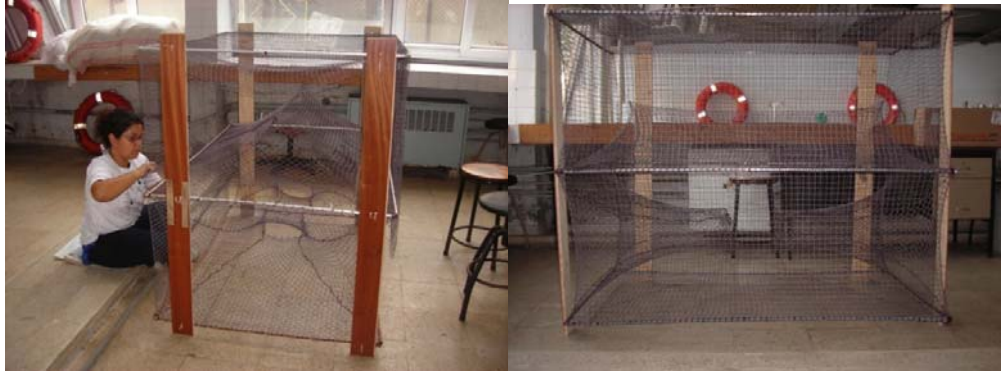
Şekil 3.10: Sepetin çevresinin kaplanarak son şeklinin verilmesi
