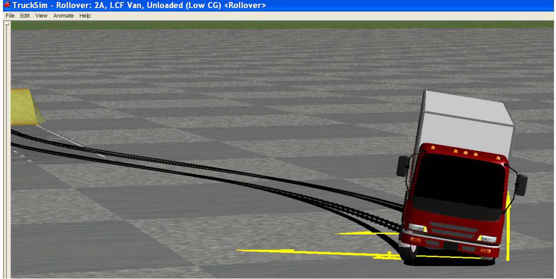
Şekil 3.11 : Bir taşıtın devrilme davranışı incelemesinden bir görüntü.
