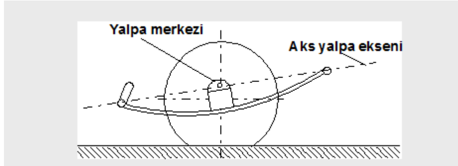
Şekil 6.3 : Katı aks asılışlarında yalpa merkezi [27].
