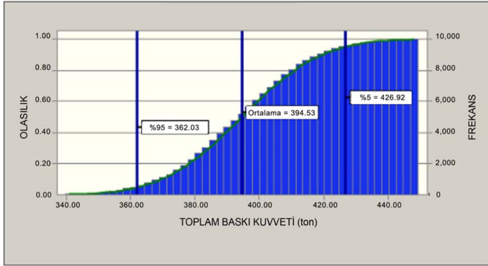
Şekil 5.11 : Kartal (Kireçtaşı) Formasyonu aynaya uygulanan toplam baskı kuvvetinin kümülatif dağılım grafiği.
