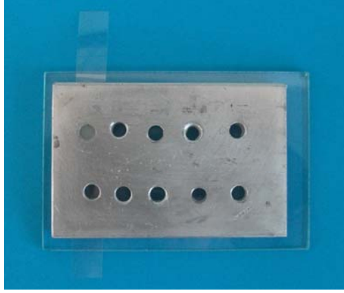
Resim 9: Siman camı ve şeffaf bant üzerindeki kalıba kompozit rezin örneğinin yerleştirilmesi.
