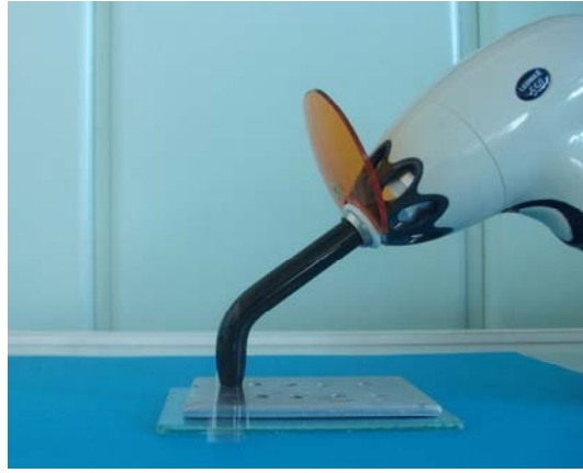
Resim 12: Hazırlanan kompozit rezin örneđe Hilux Led-max 550 ışık cihazı ile ışık uygulanması.
