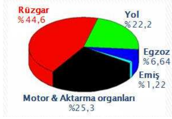
Şekil 1.2: Gürültü kaynaklarının, toplam kabin içi gürültüsüne katkı oranları [2].
