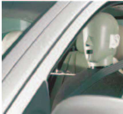
Şekil 3.9 : Araç gürültü ölçümünde HATS.
