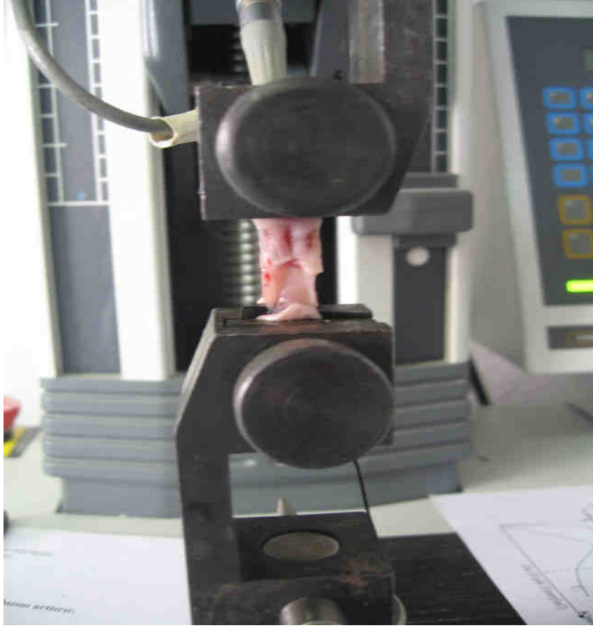
Resim 3.6: Tensinometrik çalışma (mekanik germe testi uygulaması).
