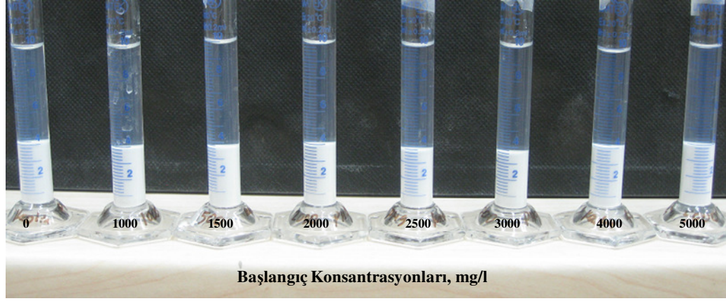
Şekil B.13 : Kalsine kaolen/NaPAA pH=9’da için çökme testi sonucu.
