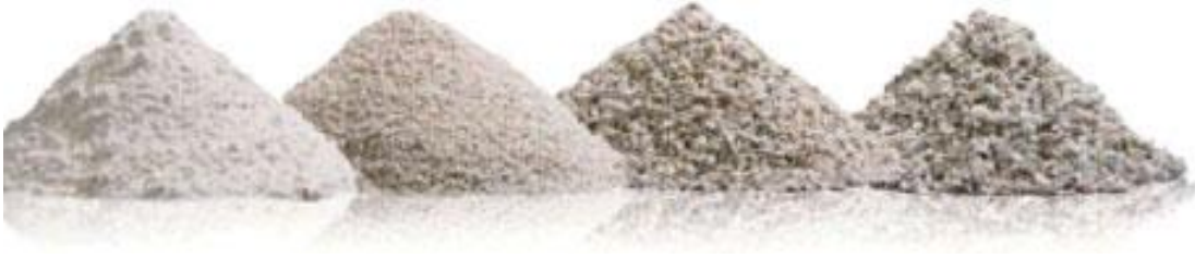
Şekil 3.1 Farklı Dane Boyutuna Sahip Kireçler (Little, 1995)
