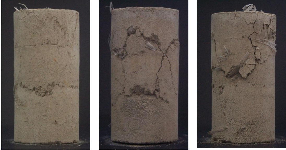
a) %0.25 Polipropilen + %15 Uçucu kül b) %0.50 Polipropilen + %10 Uçucu Kül c) %0.75 Polipropilen + %5 Uçucu Kül
