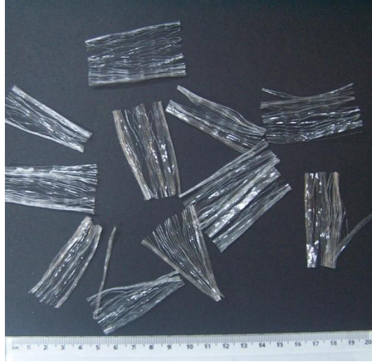
b) Deforme edilmiş polipropilen fiberler
