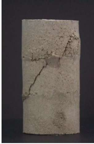
Şekil 4.13 Yalın numune w = \% 27 , q_u = 170.5 \text{ kN/m}^2
