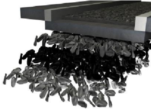
Şekil 3.10 Metal Cürufu Uygulanan Temel Kesiti (Erol, 2008)
