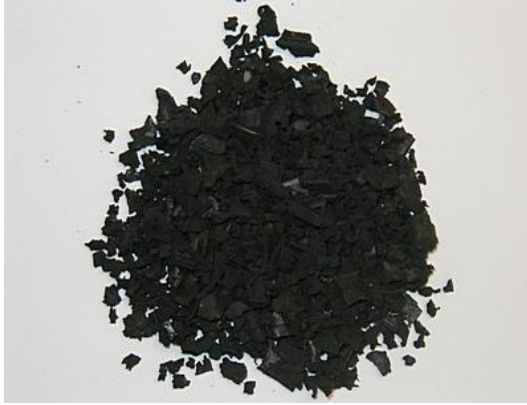
c) Granüler halde bulunan lastik parçaları
