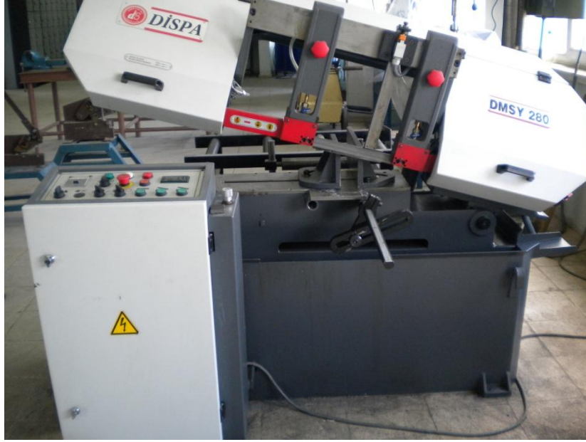
Resim 3.8 Al ve Al-12Si alaşımlı külçelerin kesildiği elektrikli testere
