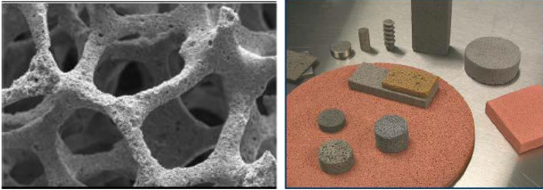
Resim 2.6 (a) : “Duocell” in görünüşü. (b) : Hassas dökümle üretilen parçalar (Ogan 2008)
