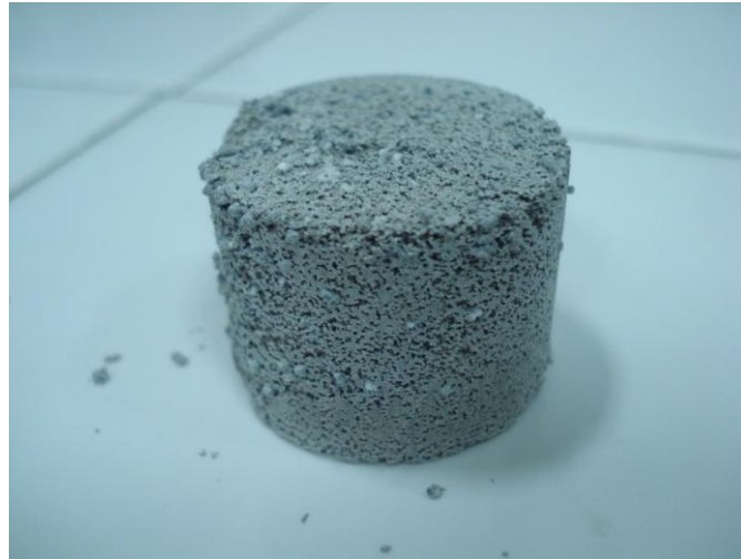
Resim 4.5 Çözme sıcaklığının 80°C seçilmesi ile numunenin yapısal bütünlüğünü koruduğu, boşluk tutucu malzeme olarak NaCl tozu içeren Al köpük
