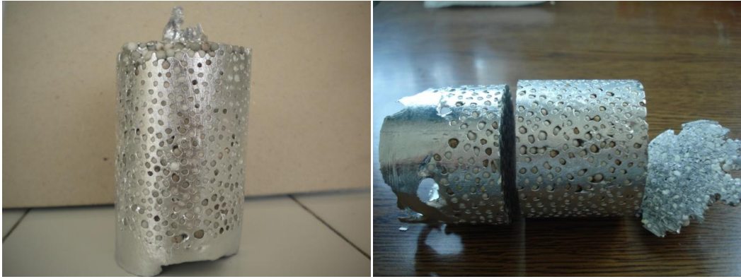
Resim 4.8 Kalıptan ilk çıkan numunenin şekli ve deneye hazır hale getirilmiş numune
