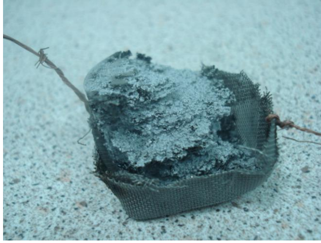
Resim 4.4 Yüksek çözündürme sıcaklığı sonrasında K_2CO_3 numunelerin aldığı form.
