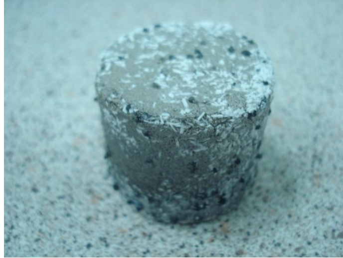
Resim 4.3 650°C’de 2 saat süre ile sinterlenmiş bir alüminyum köpük numunenin çözündürme işlemi öncesi hali
