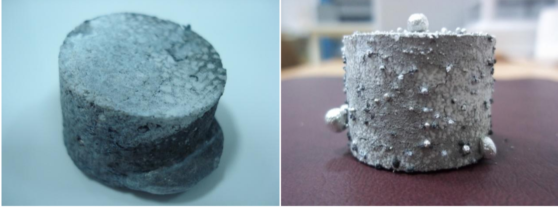
Resim 4.2 Sinterleme sıcaklığının ve sinterleme süresinin yüksek seçilmesinde meydana gelen yapısal bozukluk
