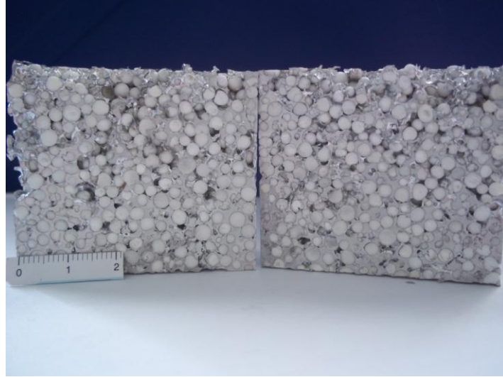
Resim 4.9 Boyuna kesilen alüminyum köpük numune
