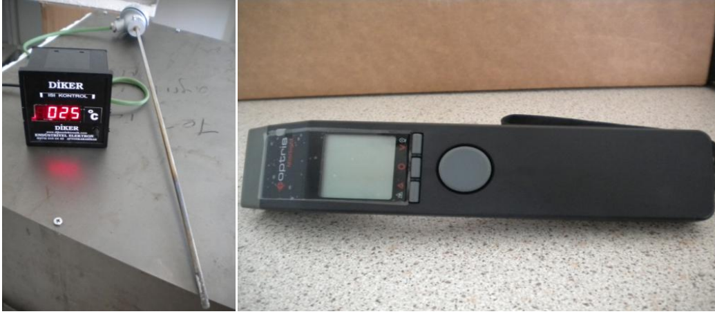
Resim 3.10 Pota ve kalıbın sıcaklığının ölçülmesinde kullanılan cihazlar
