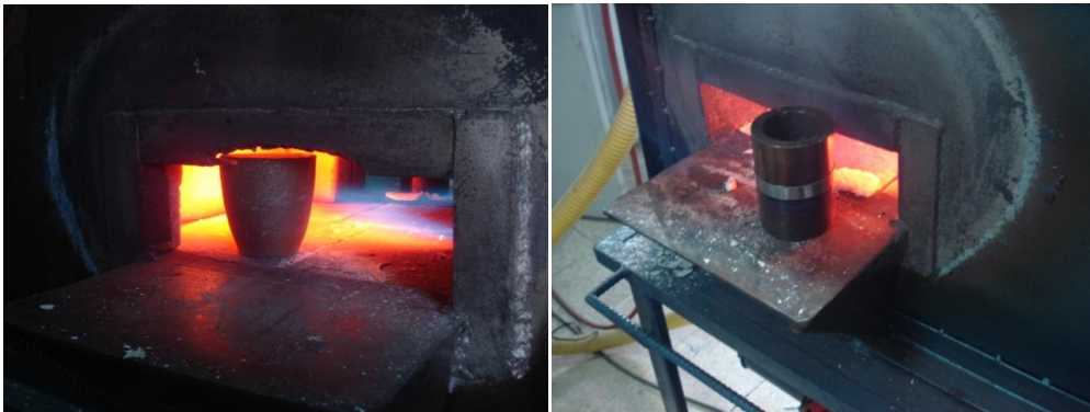
Resim 3.9 Isıtılan pota ve döküm kalıbı
