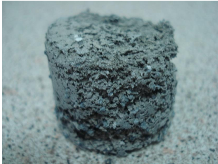
Resim 4.1 Çözme esnasında dağılmış olan alüminyum köpük numune
