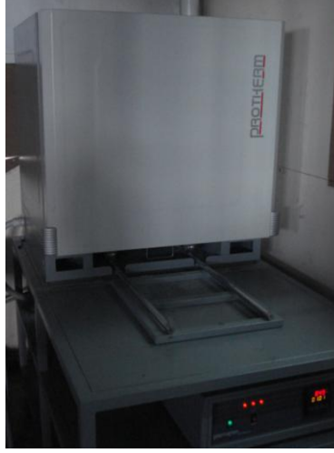
Resim 3.7 Silika jellerin genişletildiği fırın sistemi.
