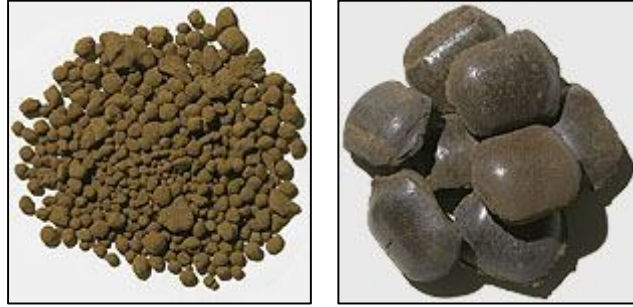
Şekil 2.4 Amerikan Prosesi'yle üretilen inko oksit taneleri ve briketleri [43]
