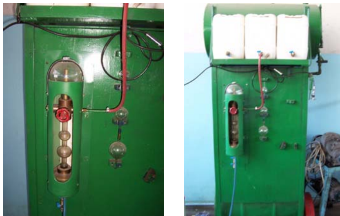
Şekil 3.5 Yakıt sarfiyatı ölçüm düzeni ve yakıt depoları
