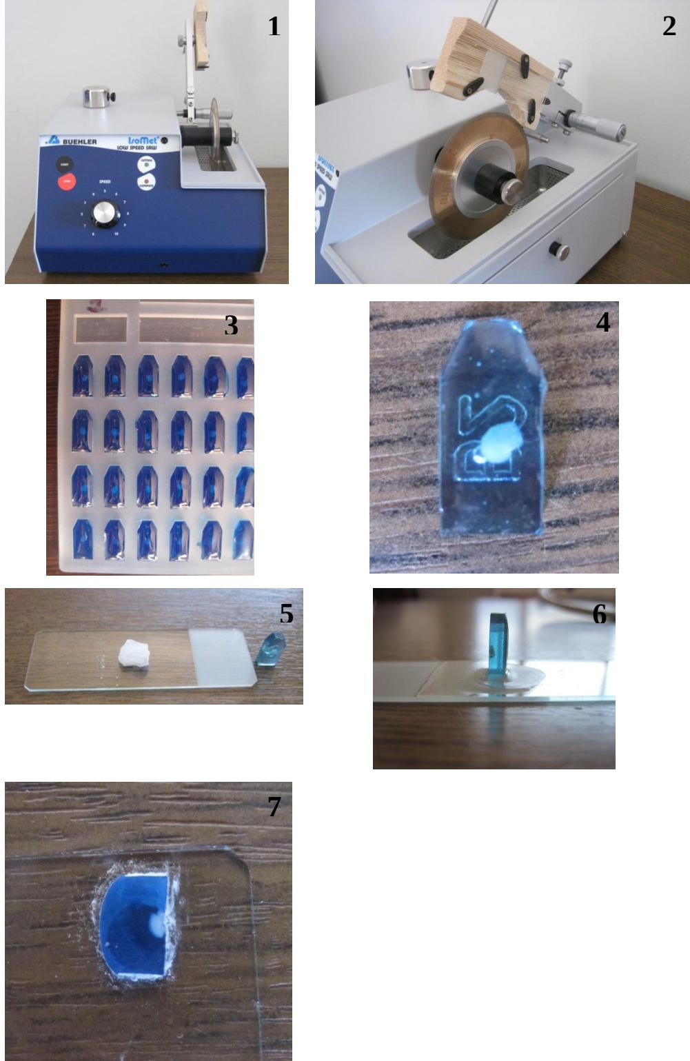
Şekil 3.5. Otolitlerin, yaş okuması öncesi geçirdiği işlemler (1:Buehler-Isomet kesim cihazı, 2: Kesit için hazırlanmış lam aparatı, 3: Polyester katalizöre gömülmüş otolit grubu, 4: Kalıptan çıkarılmış otolit, 5: Kalıbın parafin ile lama sabitlenmesi, 6: Lama sabitlenmiş kalıp, 7: Kesit alınmış ve okuma için hazır otolit.)
