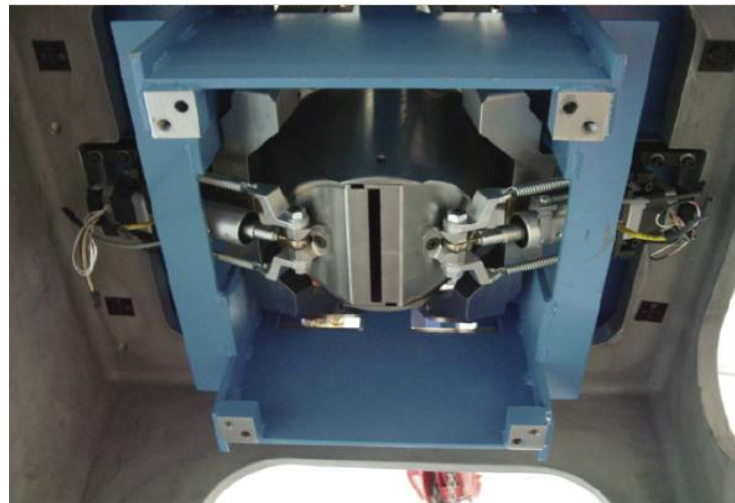
Şekil 2—13 Helikal tomoterapi kolimatör sistemi. Çeneler inferior-superior yönde hareket yeteneğine sahiptir. Alan açıklığı 1,0cm, 2,5cm ve 5,0cm olarak seçilebilir.
