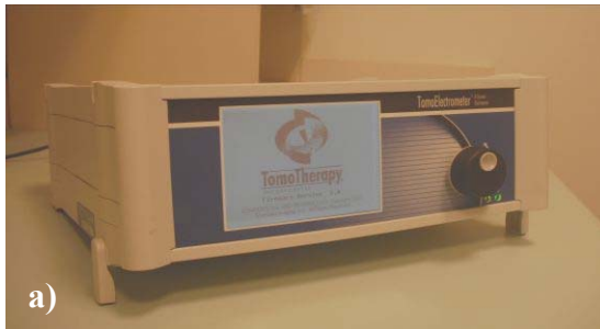
Şekil 3—10 Standart imaging çok kanallı elektrometre a) önden ve b) arkadan görünüşü
