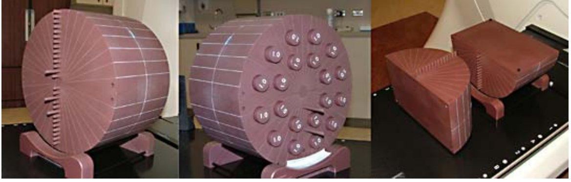
Şekil 3—3 Cheese fantom. Fantom ortadan ikiye ayrılabilir ve film düzlemine dik olarak açılmış olan iyon odası yuvaları yardımı ile değişik noktalarda nokta doz ölçümleri yapılabilir.
