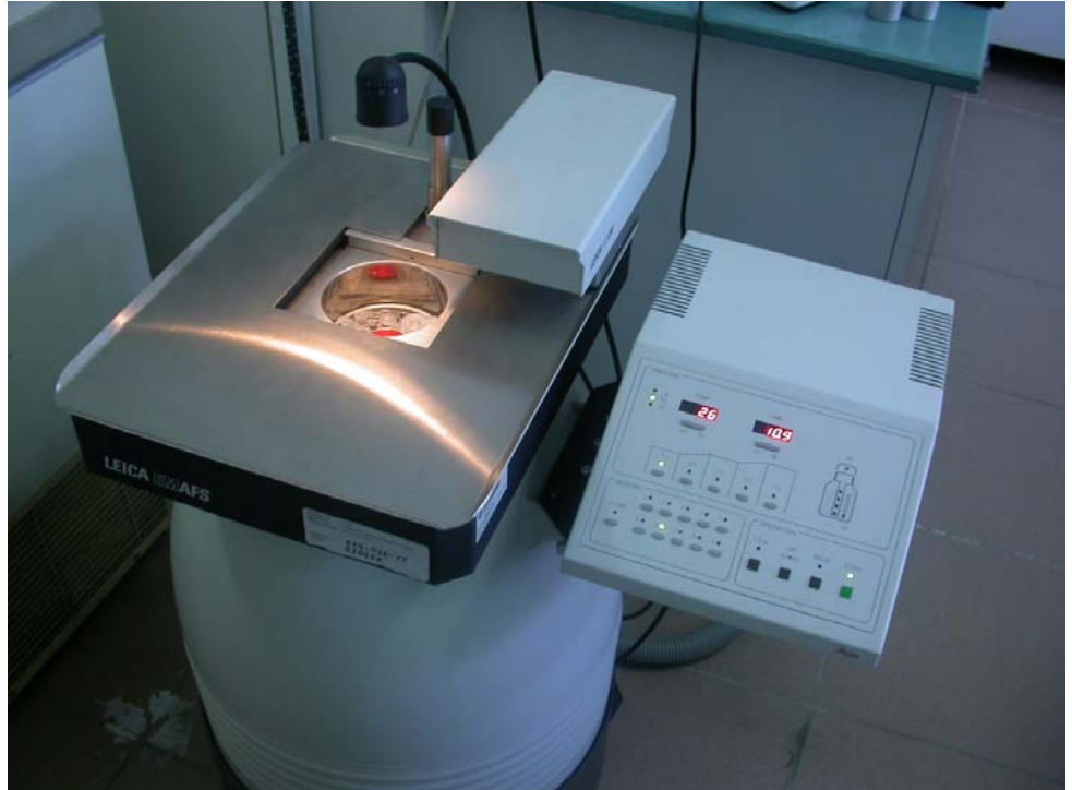
Şekil 2.4: Automatic Freeze Substitution System cihazında lowicryl serilerinin gerçekleştirilmesi
