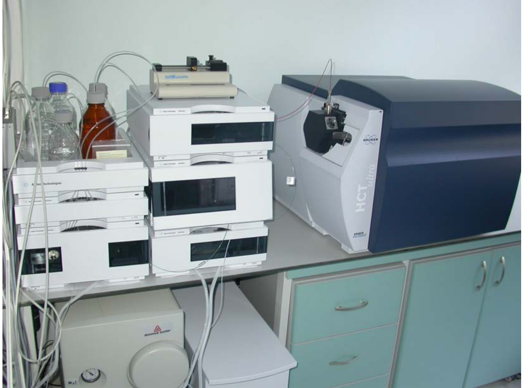
Şekil 2.3: Kapiler HPLC (Agilent 1200) - Elektro Sprey İyonizasyon - Kütle Spektroskopisi Bruker Daltonics ) sistemi.
