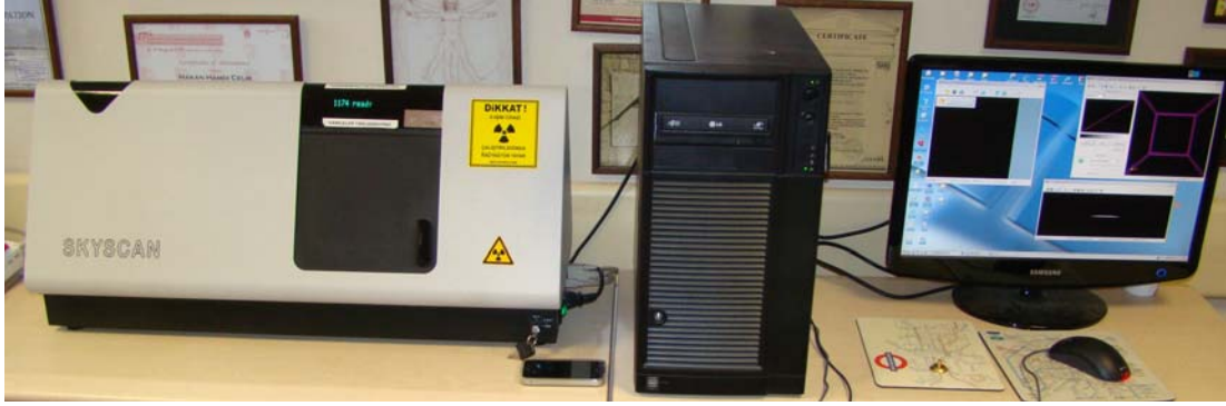
Şekil 3.8 Araştırmada kullanılan SkyScan 1174 mikro tomografi cihazı ve CT-Vol analiz programı.
