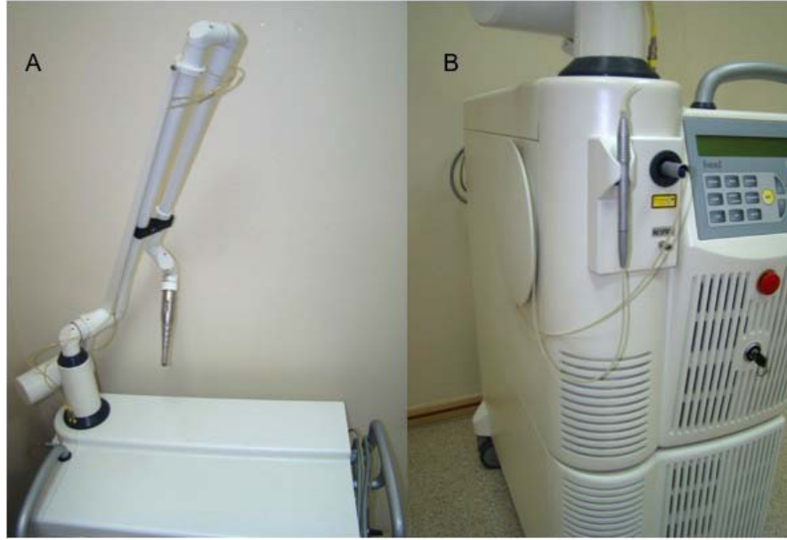
Şekil 2.3 (A) Hareketli kol ile iletilen lazer sisteminin sistemi, (B) Fiber optik kablolu lazer iletim sistemi.
