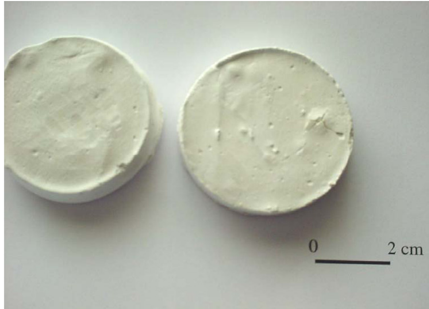
Şekil 3.3. Hacim değişmezliği tayini yapılan kireç tabletleri (Kılıç, 2005)
