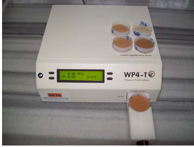
řekil 3.7. Emme basıncının WP4-T potansiyometre ile belirlenmesi
