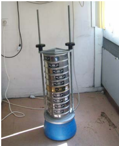
Şekil 3.2. Titreşimli alet ile elek analizi
