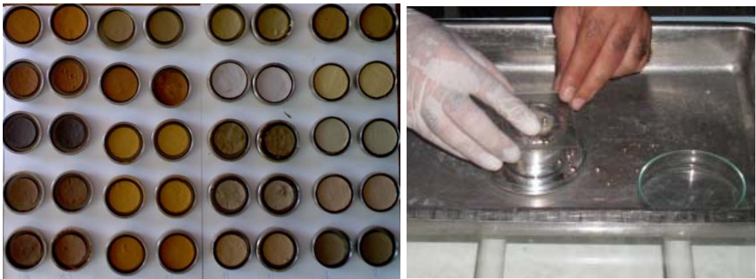
Şekil 3.5. Büzülme Limiti deneyinin yapılışı (solda etüvden çıkartılan örnekler, sağda civa taşırılarak örnek hacminin bulunması)
