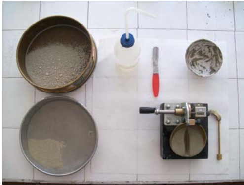
Şekil 3.4. Kıvam limitlerinin belirlenmesi: likit limit (solda), plastik limit (sağda)
