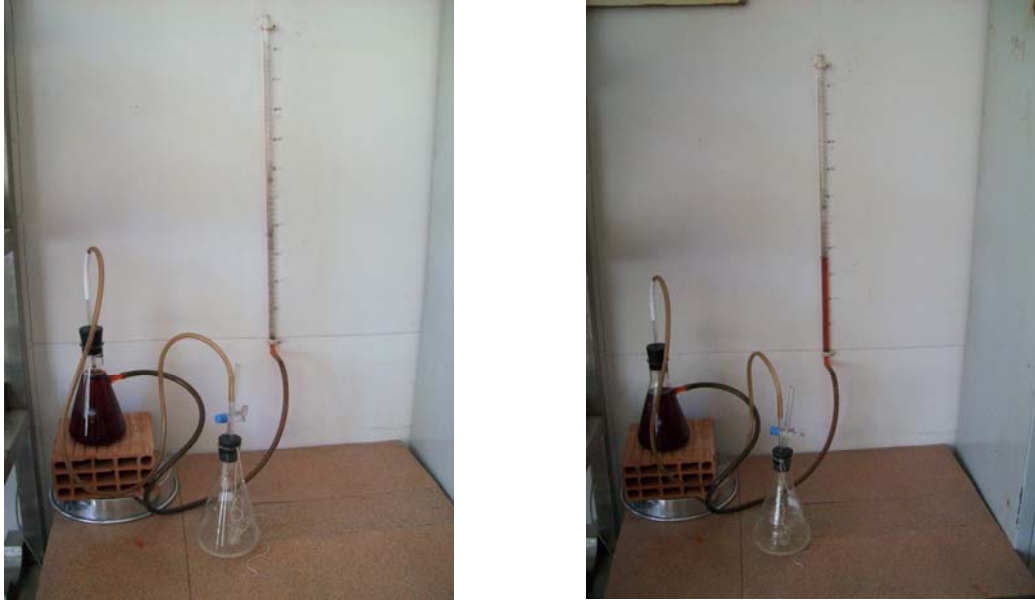
Şekil 3.9. Toplam karbonat deneyi için hazırlanan düzenek A) Solda reaksiyon başlamadan sistem denge durumunda B) Sağda reaksiyon sonunda \text{CO}_2 gazının çıkması ile duvara monte edilmiş dereceli silindirde yükselme
