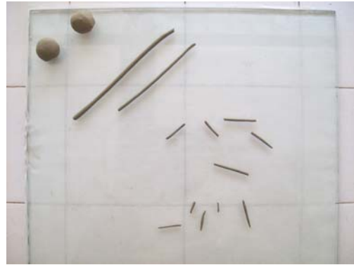
Şekil 3.4. Kıvam limitlerinin belirlenmesi: likit limit (solda), plastik limit (sağda)
