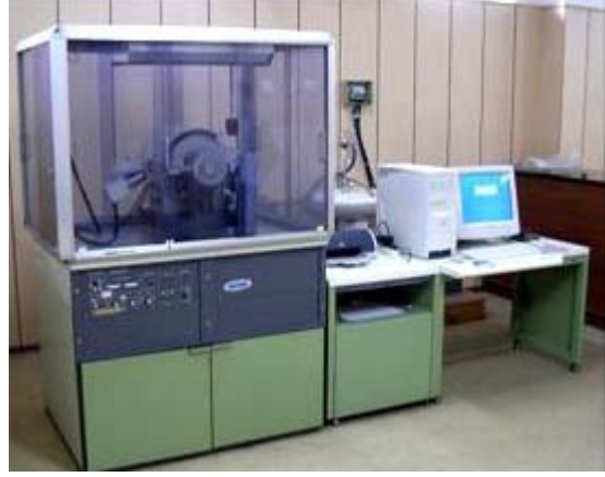
Şekil 3.11. Cu X-ışın tüplü Bruker D8 Advance XRD analiz cihazı (Resim www.mta.gov.tr adresinden alınmıştır)
