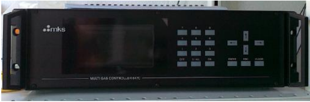
Şekil 3.13.Gaz Akış-Basınç Kontrol Sistemi
