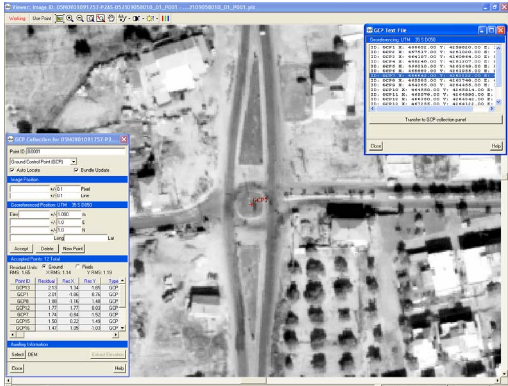
Şekil 8.2. Karaburun ilçesi pilot alanlarına QuickBird uydu görüntüsünde PAN bandının ortorektifikasyonu ve yer kontrol noktalarının (GCP) gösterimi
