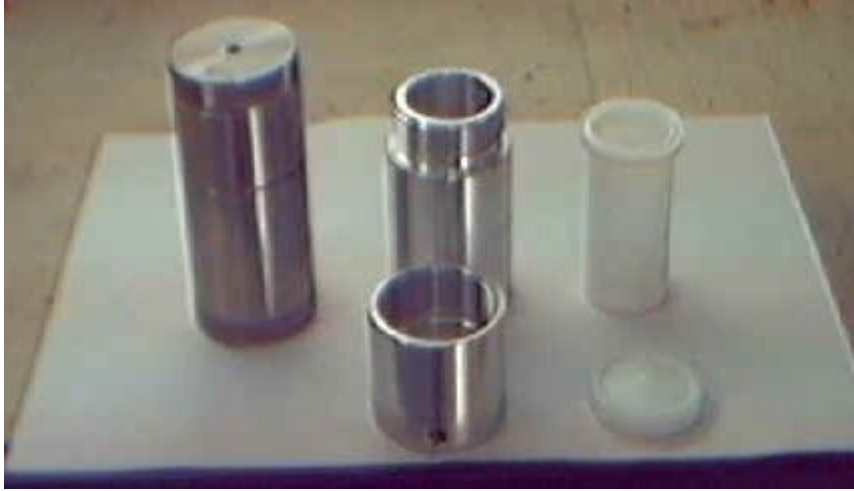
Şekil 3.2. Hidrotermal yöntemde kullanılan otoklav ve teflon kap
