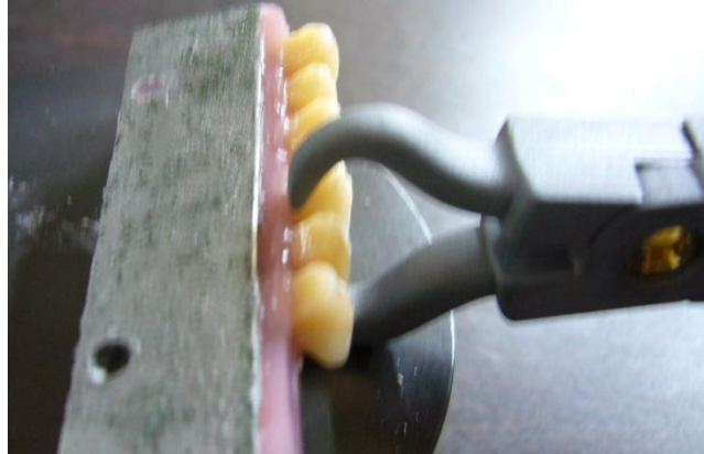
Resim 22. Numune dişlerin protez kaide polimerine bağlanmalarının test edilmesi için metal kalıbın sabitlenmesi ve dişlere kuvvet verilmesi.
