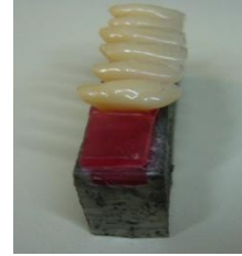
Resim 20. Protez kaide polimerine bağlanma deneyi için numune dişlerin yerleşeceği metal kalıp ve mum kaidenin hazırlanması.
