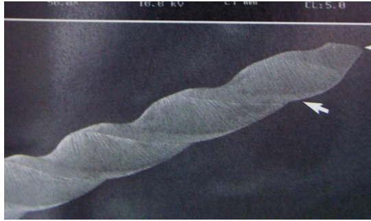
Resim 1.7. GT nikel titanyum döner enstrümanın bıçak kenarı ve kesici olmayan alet ucu
