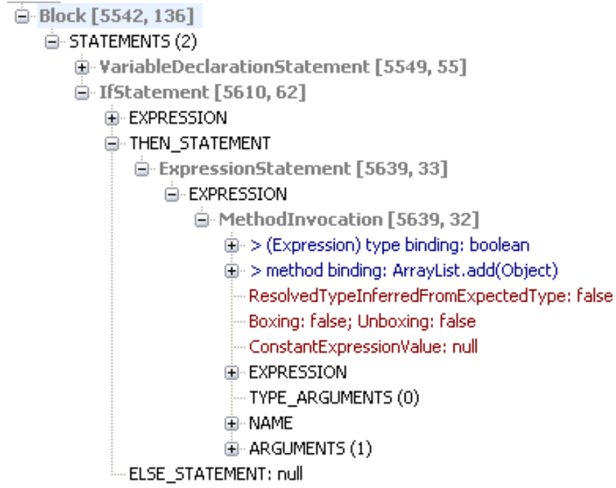
Şekil 4.14. Blok yapısı içerisindeki bir metod çağırımı (MethodInvocation).
