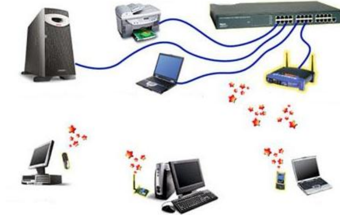
Şekil 2.20 : Altyapı Model WLAN Mimarisi
