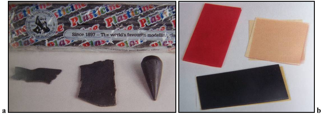
Resim 4.28. Kalıp malzemesi olarak kullanılan plasterin ve dişçi mumu (Koob, 2006, 79-80).
