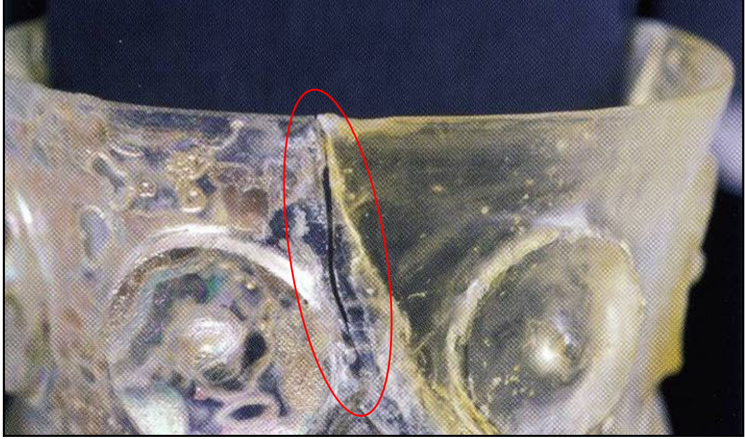
Resim 4.33. Doğrudan döküm tekniğiyle yapılmış epoksi reçine tümleme (Koob, 2006, 49).
