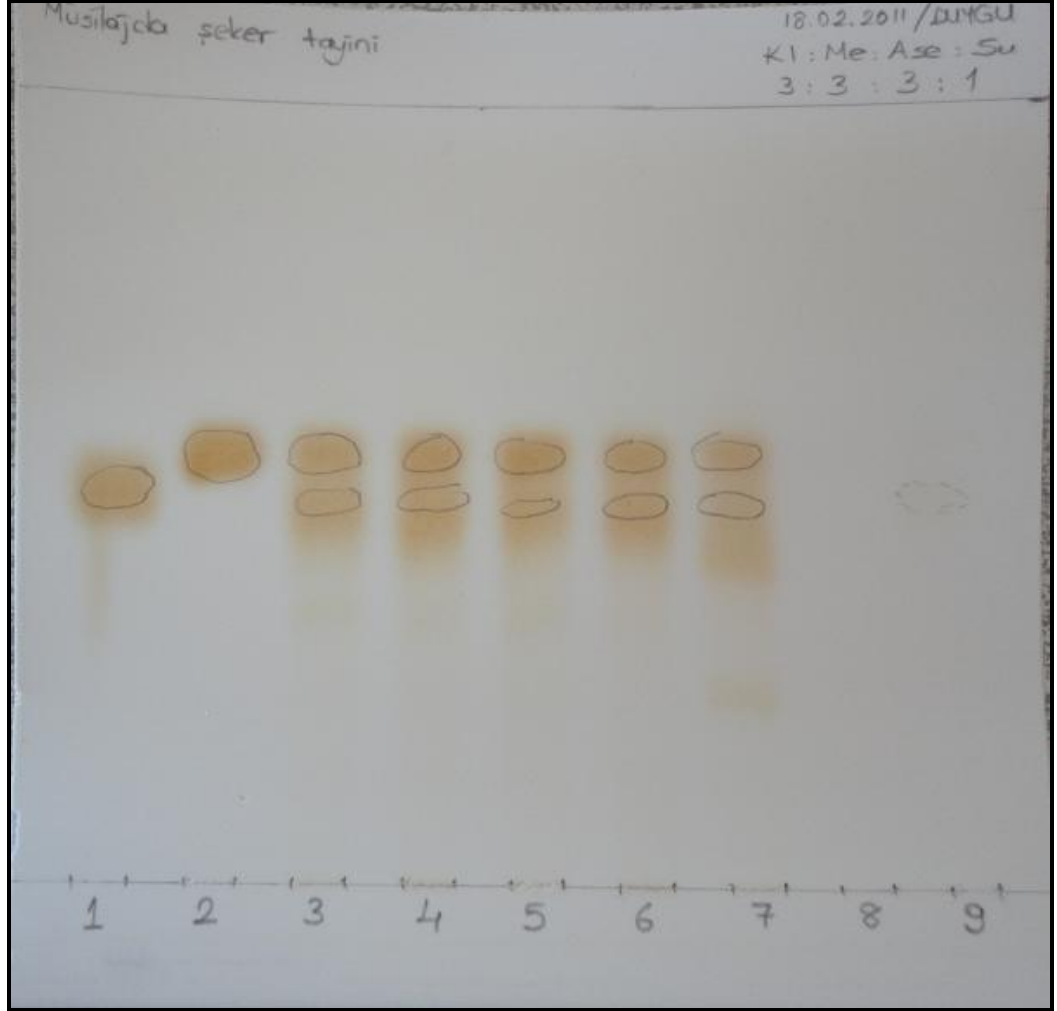
Şekil 18: Psyllium tohumu ve preparat örneklerinin İTK'da, anilin ftalat R sonrası görünüşü (105°C, 10 dk)
