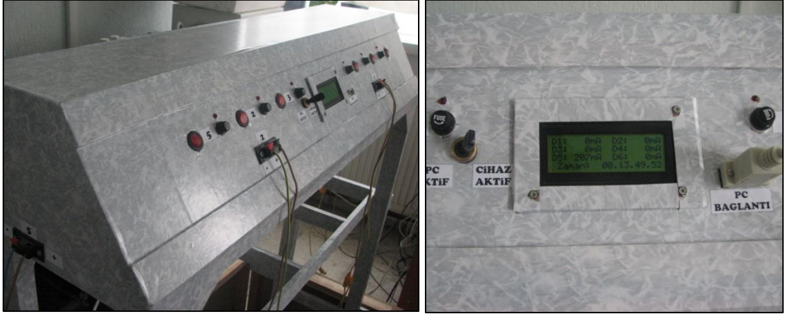
Resim 3.14. Hızlandırılmış korozyon düzeni kontrol paneli
