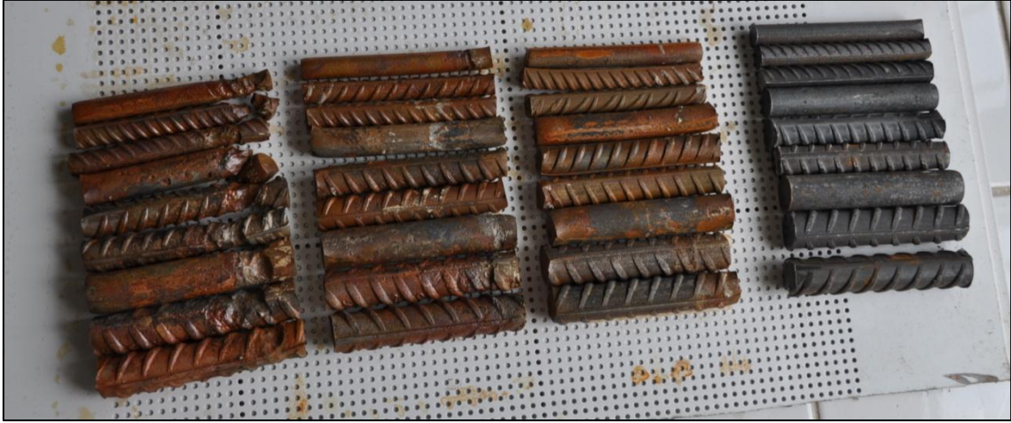
Resim 3.20 Clarke çözeltisiyle temizlenmiş çubuklar
