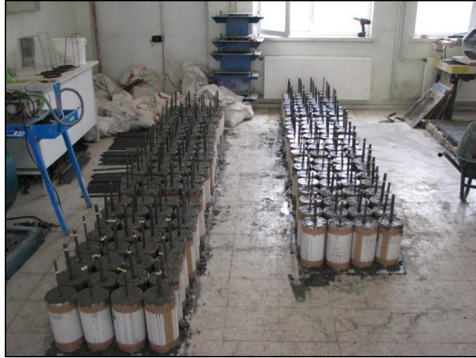
Resim 3.2. Bir beton serisi için üretilen lolipop şeklinde numuneler
