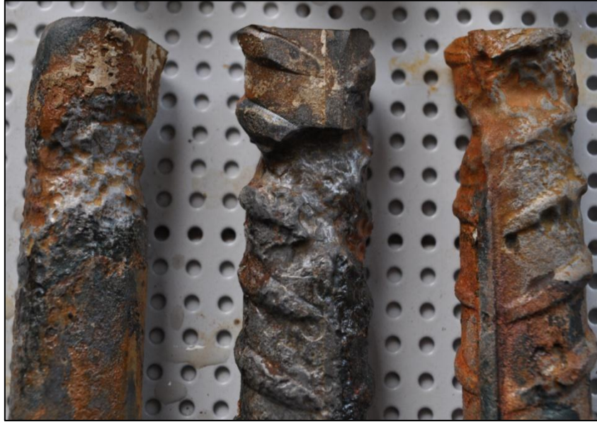
Resim 3.21 Clarke çözeltisiyle temizlenmiş 20 mm'lik çubuklar
