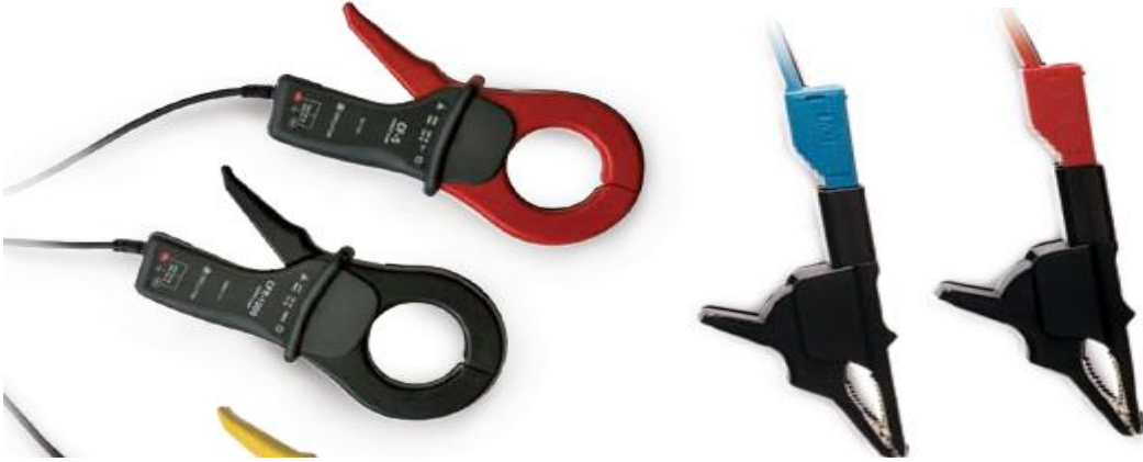
Şekil 3.5. Ölçümlerde kullanılan akım ve gerilim klempleri
