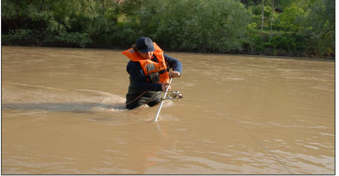
Şekil 3.14 Akarsuya girilerek yapılan akım ölçümlerinde kullanılan muline aleti
