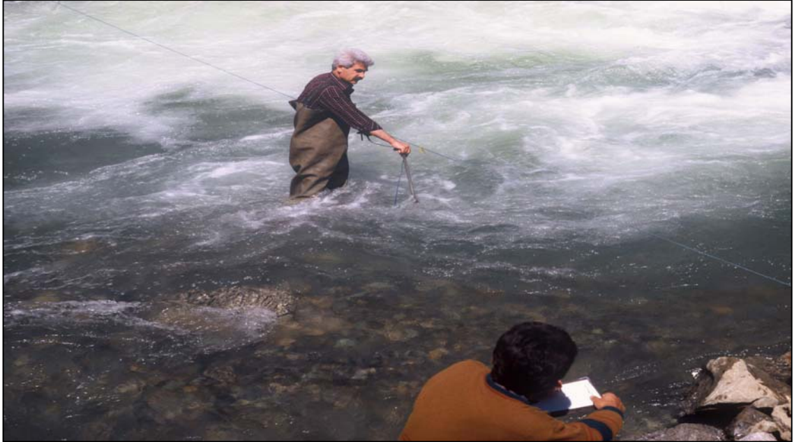
Şekil 3.15 Akarsuya girilerek yapılan akım ölçümü
