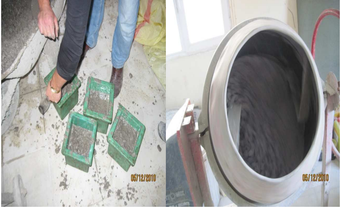
Şekil 2.12. Beton numune alma kalıpları ve betoniyein görüntüsü
