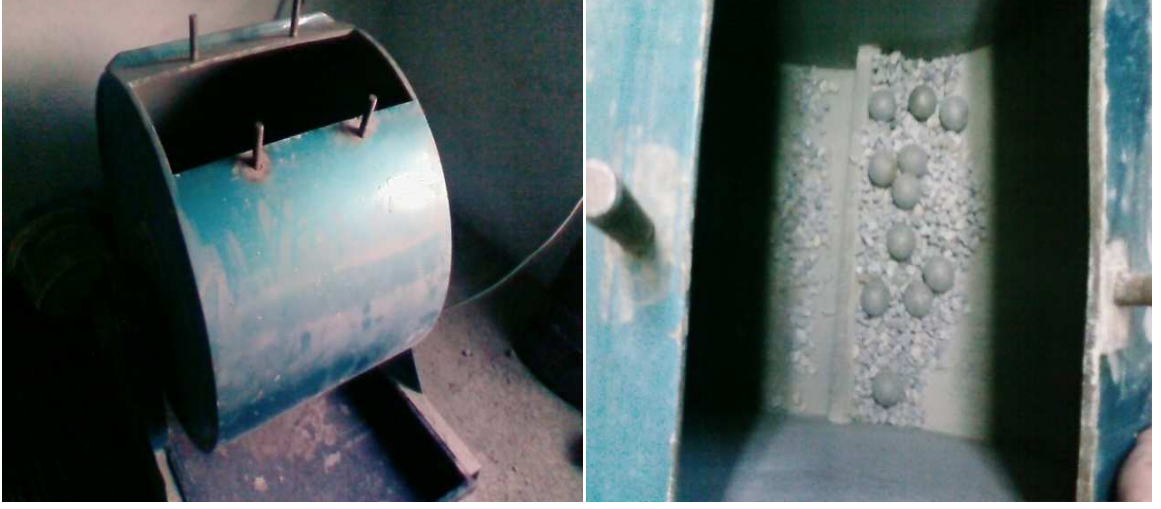
Şekil 1.2. Los Angeles makinesinin iç ve dış görünüşü
