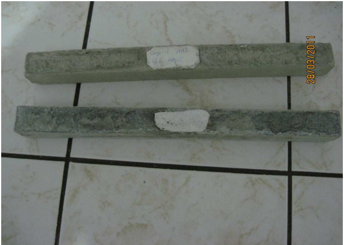
Şekil 2.18. Aynı agregaya ait harç çubuklarının deney öncesi ve deneye maruz kalmış görüntüleri
