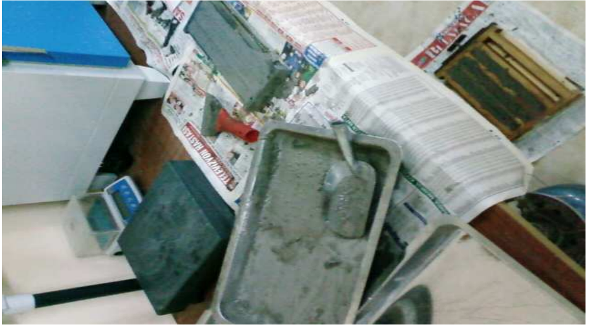
Şekil 2.16. Harç çubuklarının kalıplara dökülmesinin görüntüsü
