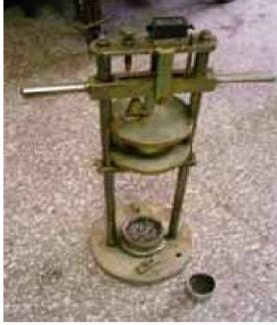
Şekil 1.3. Agregada darbe dayanımı test cihazının görünüşü
