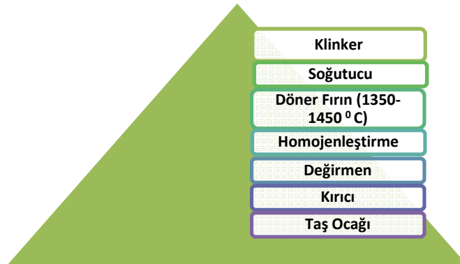
Şekil 1.9. Klinker üretimi akım şeması blok diyagram
