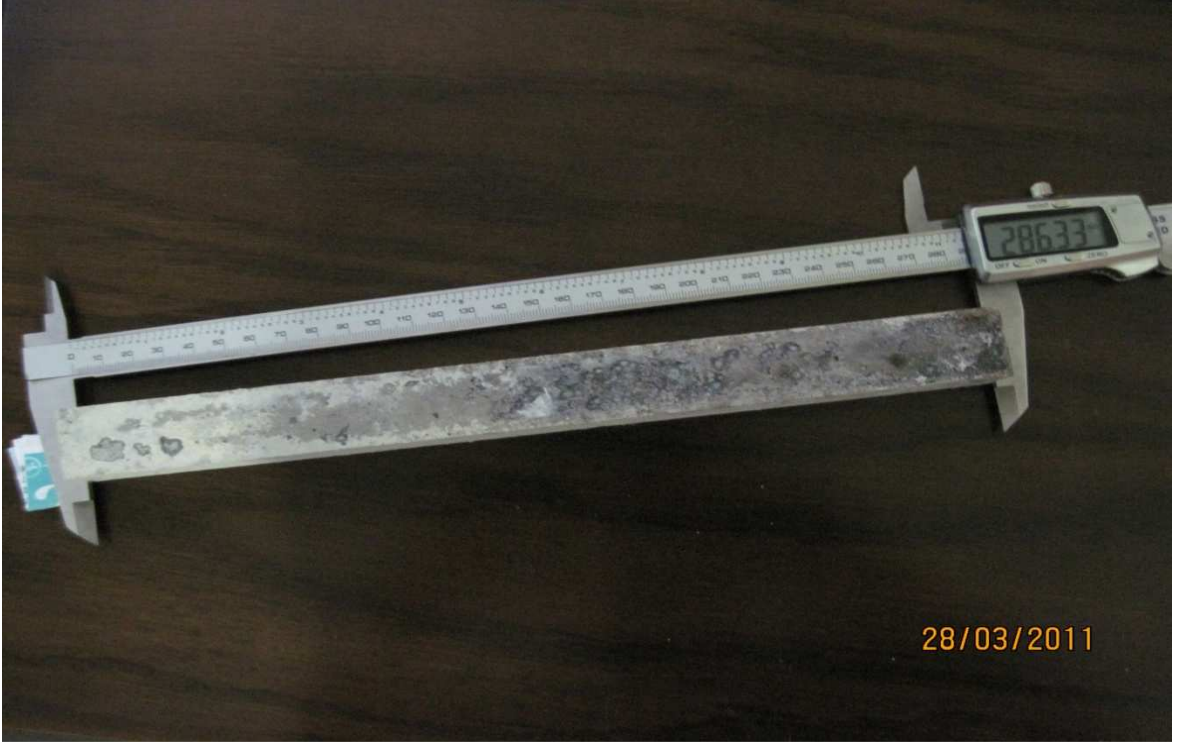
Şekil 2.19. Harç çubuklarının hassas boy ölçümleri
