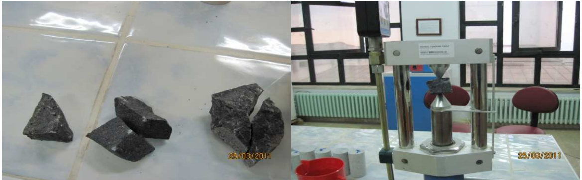
Şekil 2.10. Nokta yükleme deney aleti ve numunelerin görünüşü
