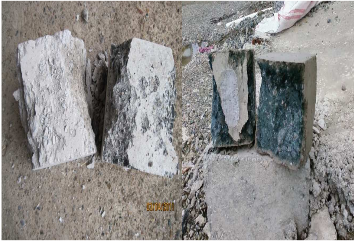
Şekil 2.13. Prestele kırılmış beton numunelerinin görünüşü (soldakiler çimento bağlayıcılı, sağdakiler aktifleştirilmiş yüksek fırın cürufu bağlayıcılı numuneler)
