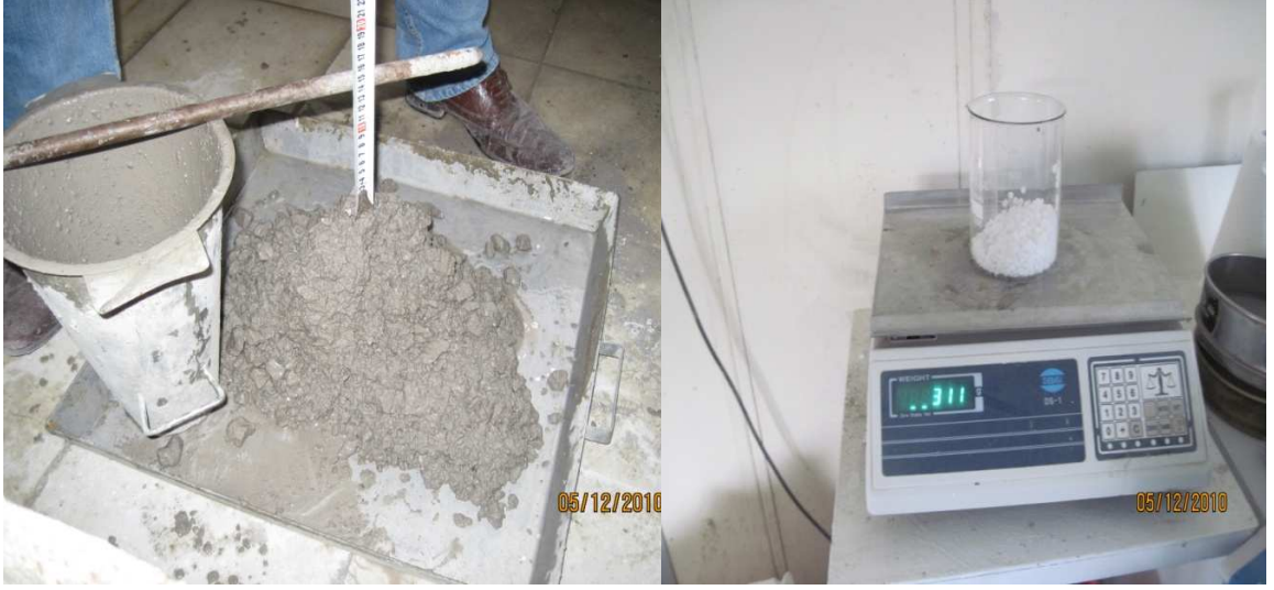
Şekil 2.14. Yaş betonların slump ölçüm hunisi ve bileşenlerin hassas terazi ile tartılması
