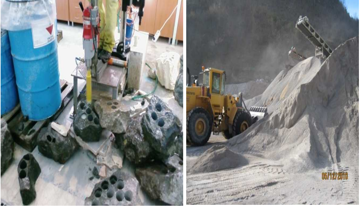
Şekil 2.4. Kayaçlardan karot alımı ve agreg a numunesi alınan yığ ınların görüntüsü
