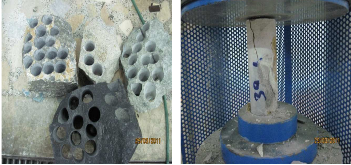
Şekil 2.11. Blok kayalar ve deneye tabii tutulan karot numunesinin görünüşü
