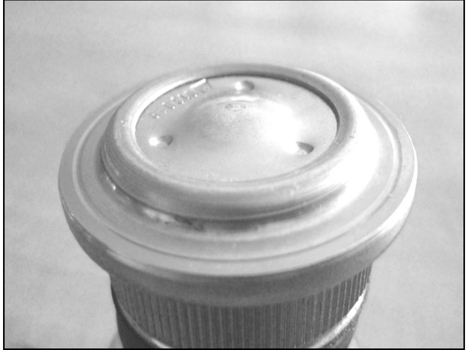
Şekil 4.5 Başarılı şekilde sıvanmış küresel yatak (X90 SBJ)
