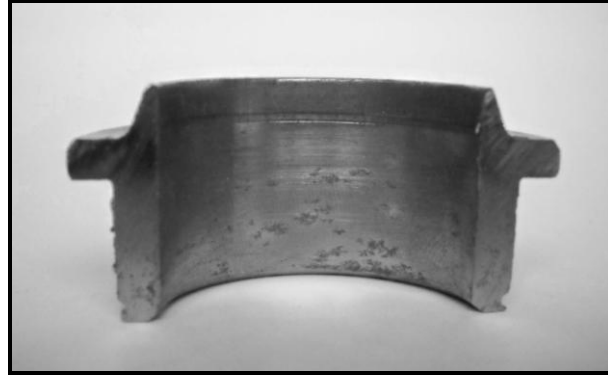
Şekil 6.9 İç yüzeyinden talaş alınmış rotilin en kesit görünümü
