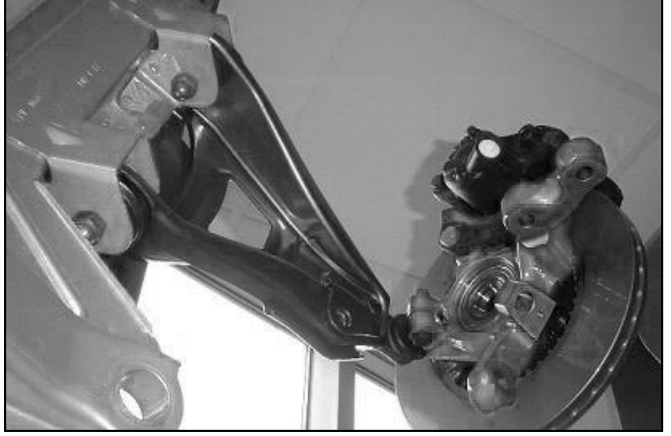
Şekil 3.7 Renault Clio alt salıncak kolu, rotili ve aksonu (Kırlı, 2009)
