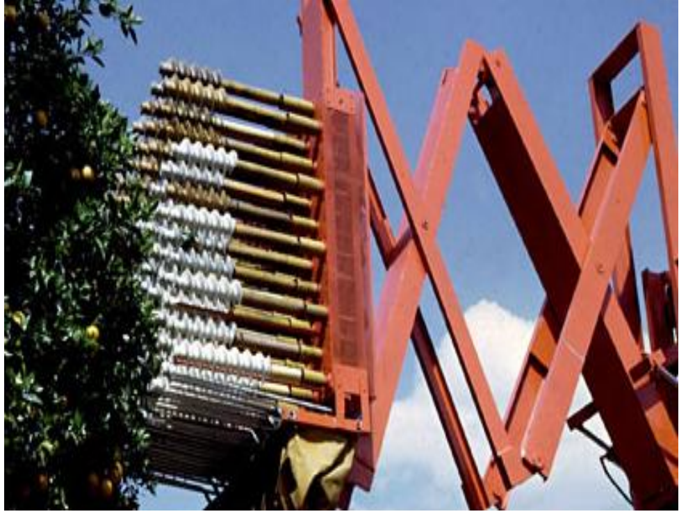
Şekil 1.4 Portakal hasat makinesi (Anonymous 2010)
