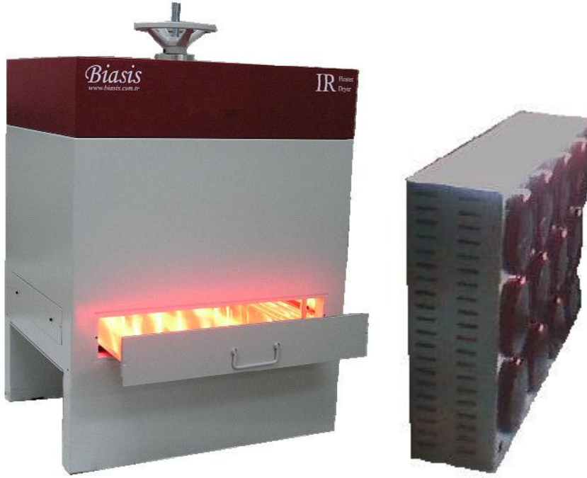
Şekil 3. 1. İnfrared cihazı (Infrared Heater-Dryer), yakın kızılötesi lamba sistemi ve havalandırma kanalları
