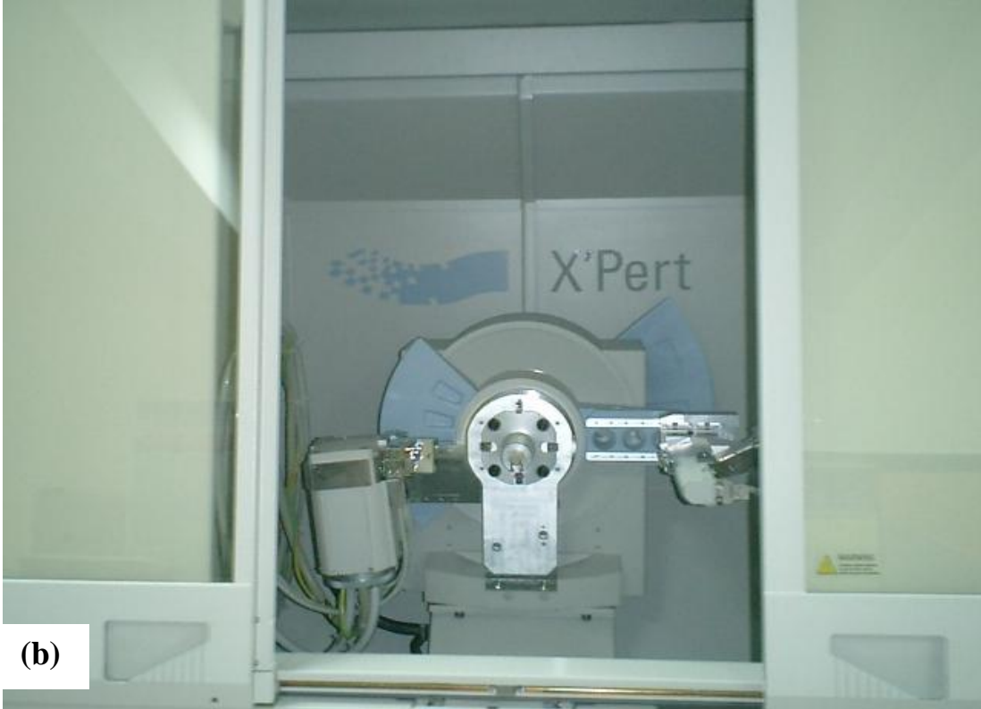
Şekil 4.10.b. Philips X'Pert PRO marka X- ışını difraksiyonu cihazının iç görüntüsü
