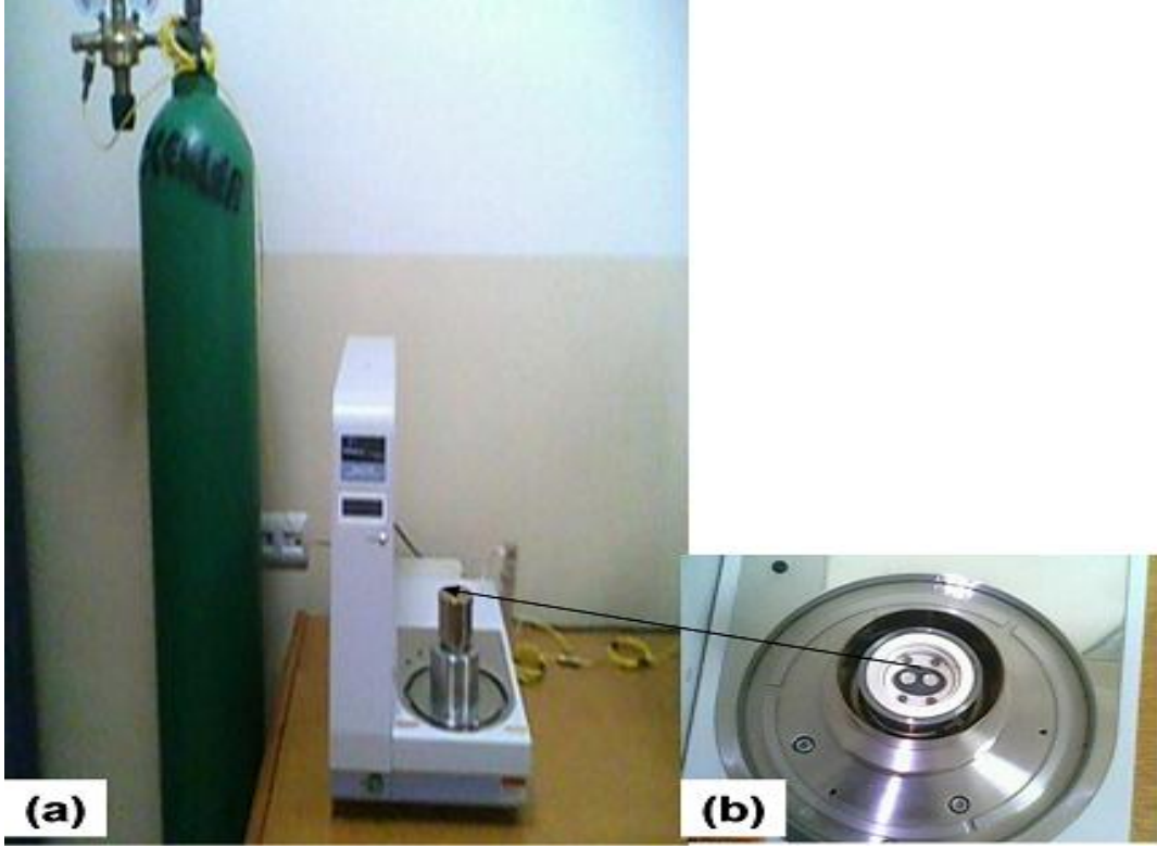
Şekil 4.9. (a) Perkin Emler-Sapphire DSC cihazı, (b) Perkin Emler-Sapphire DSC cihazı numune haznesinin iç görüntüsü
