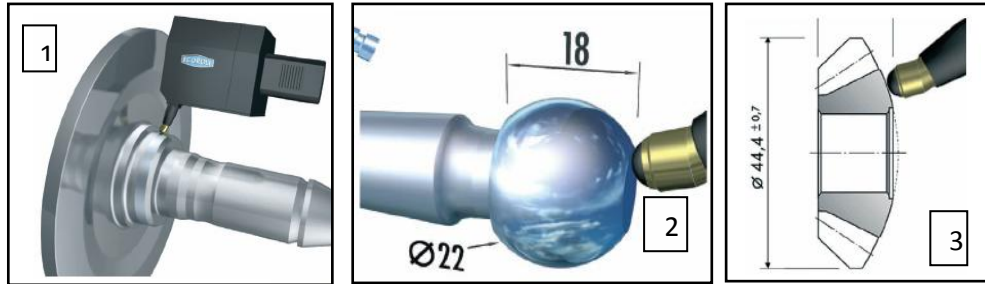
Şekil 2.10. Otomotiv Endüstrisinde Derin Haddelemeye Örnek Uygulamalar *1. Aks 2. Direksiyon mafsalı 3. Diferansiyel Dişlisi (Ecoroll 2006)
