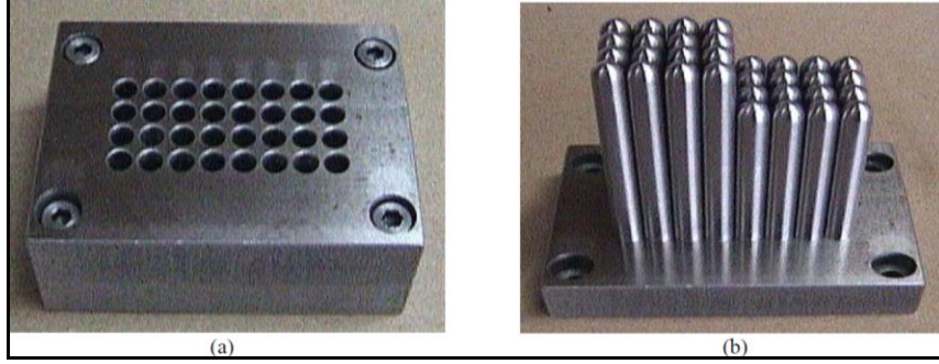
Şekil 2.2. Zımba plakası ve zımbaların montajlı ve montajsız hali *(a) Zımba plakasına zımba montaj deliklerinin delinmesi (b) Zımbaların yerlerine montaj edilmesi (Korkmaz 2005)
