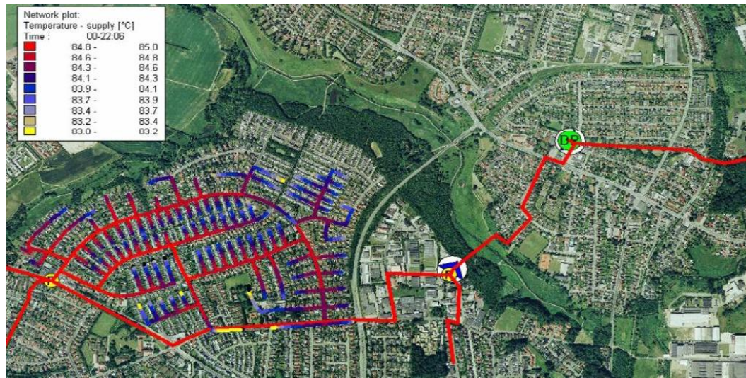
Şekil 2.14 Horning Fjernvarme bölge ısıtma sistemi boru şebekesi
